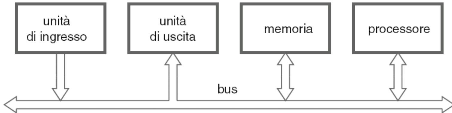
Figura 1.3 Calcolatore strutturato intorno a un solo bus.
