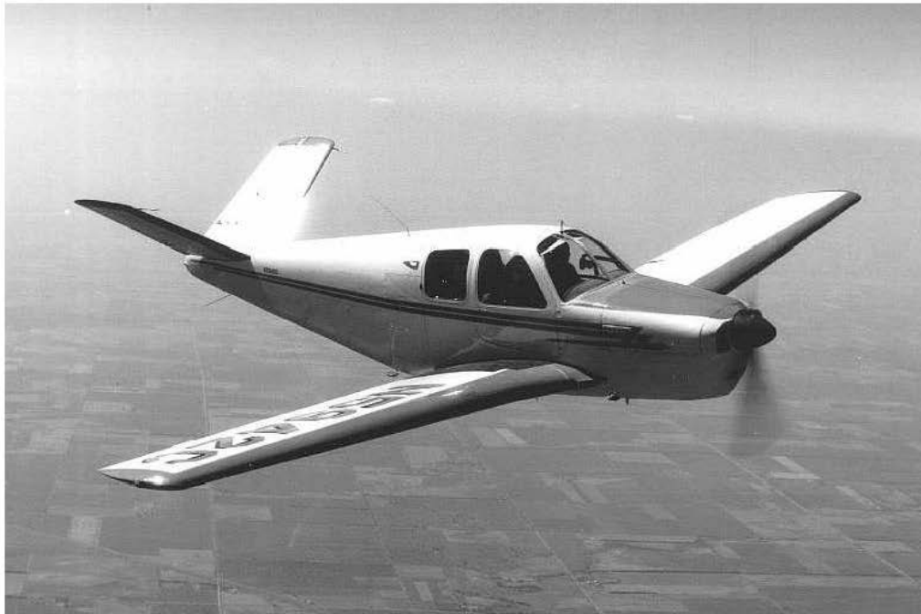
(c) Il Beech 35 Bonanza , dotato di con impennaggio di coda a “V”.
