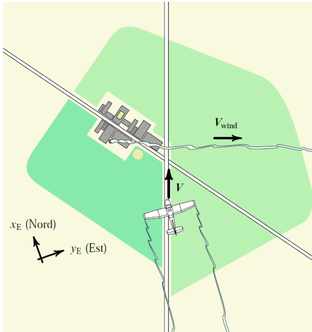
Figura 1.11 Terna di riferimento \mathcal{T}_E e volo in prossimità del suolo. In generale, anche l'atmosfera è in moto rispetto alla Terra. Nell'illustrazione il velivolo trasla rispetto al suolo con velocità V e l'atmosfera trasla macroscopicamente con velocità V_{wind} .
