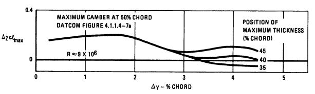
FIGURE B-5 EFFECT OF POSITION OF MAXIMUM THICKNESS ON SECTION MAXIMUM LIFT
