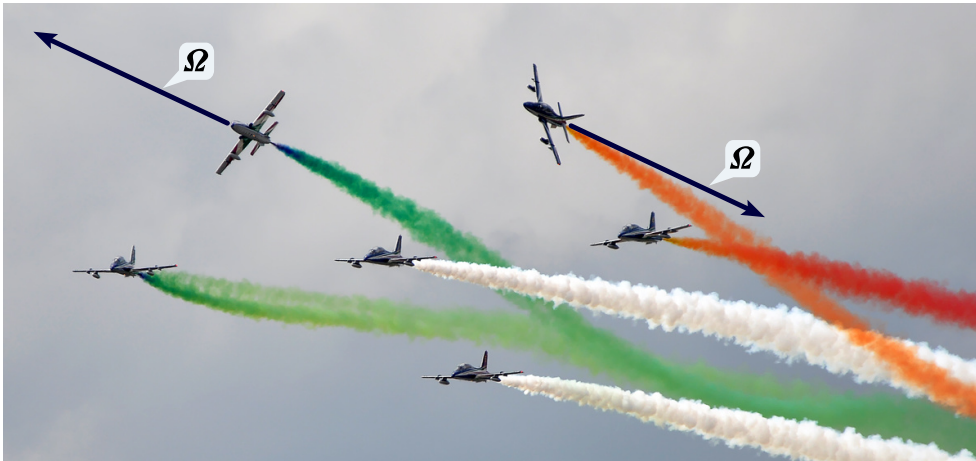
(b) Velocità angolare di rollio p positiva e negativa.
