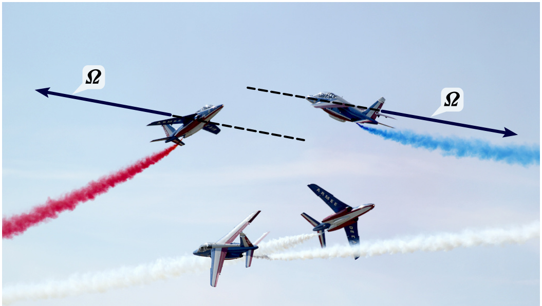
(b) Vettori velocità angolare istantanea allineati con gli assi laterali.
