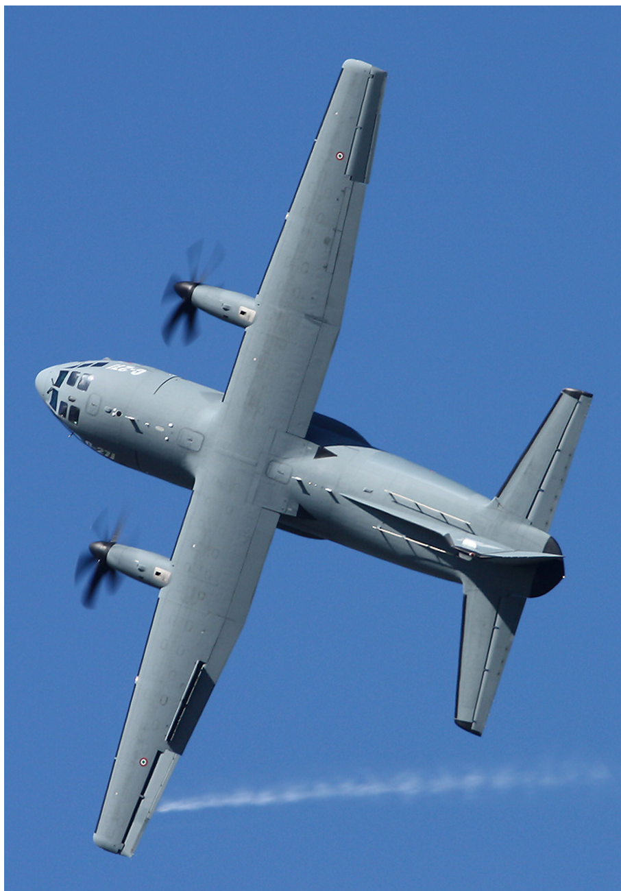
Figura 1.23 Nel moto di imbardata il pilota imprime al velivolo una rotazione intorno all'asse direzionale z_B . Nell'immagine si noti la deflessione del timone e la linea di fumo rilasciata dall'ala sinistra, da cui si deduce la velocità asintotica della corrente.
