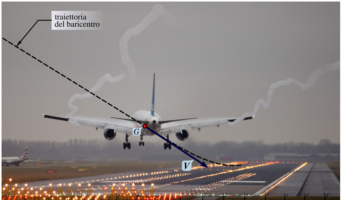
Figura 1.10 Atterraggio con vento laterale proveniente da sinistra. Il velivolo ha il “muso nel vento” e la traiettoria di discesa è allineata con la pista.
