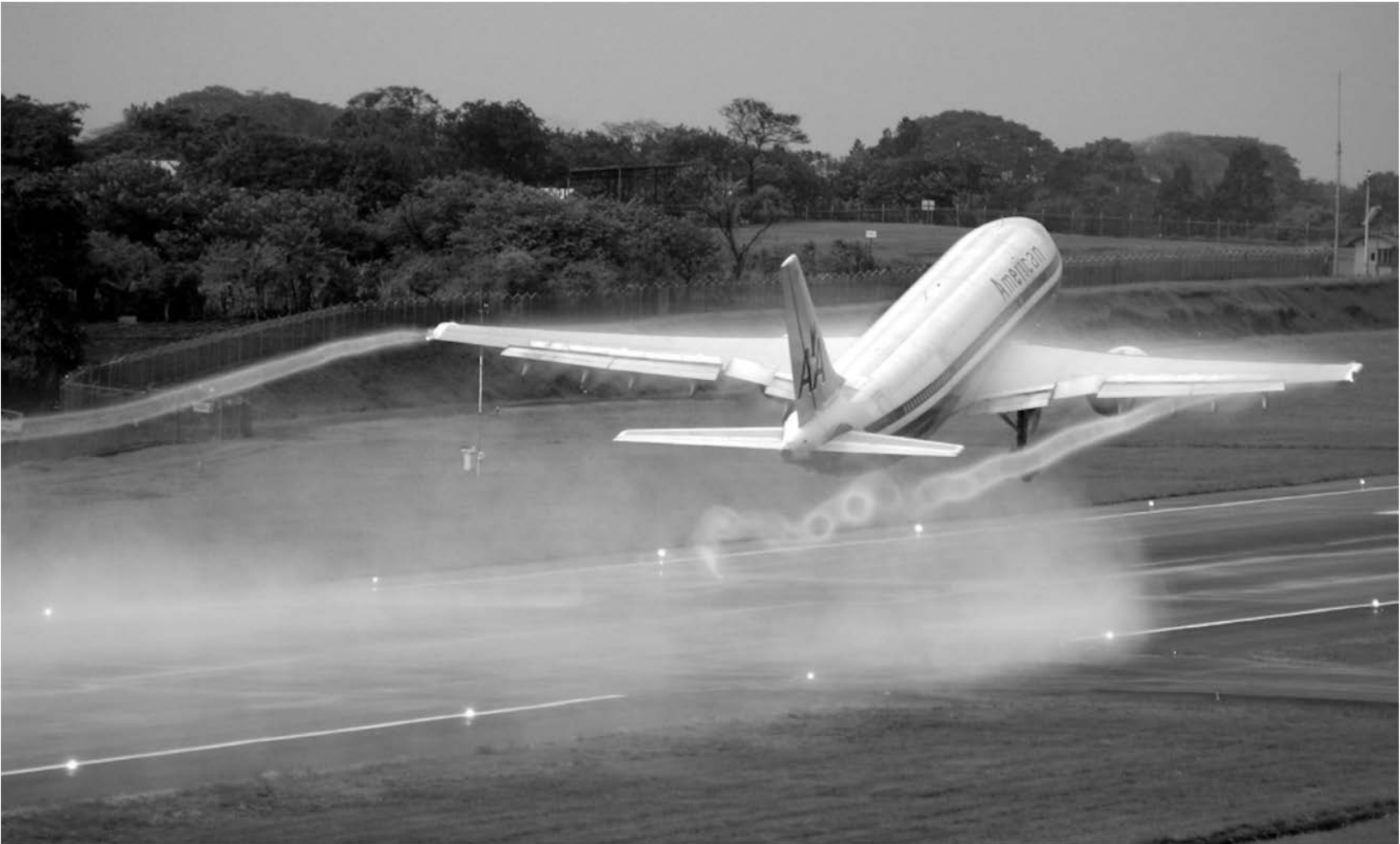
Figura 4.10 Vortici d'estremità visibili ad occhio nudo in particolari condizioni atmosferiche.
