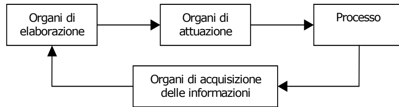
Figura 1.4 Struttura base di un sistema di automazione elementare
