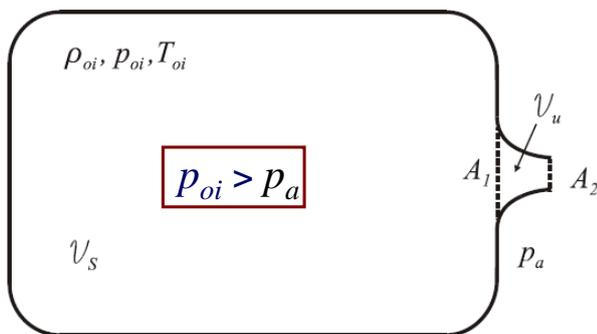
Si consideri ora il sistema rappresentato in figura costituito da un **serbatoio**, in cui è contenuto un **gas inizialmente alla pressione  $p_{oi}$** , collegato ad un **ugello convergente**.
