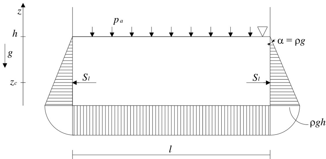
Nota la distribuzione della pressione, è possibile ricavarsi il valore delle spinte esercitate sulle pareti del recipiente effettuando un integrale della pressione esteso alla superficie interessata. Sulla parete di fondo, data l'uniformità della pressione, la spinta risulta essere banalmente pari a:
