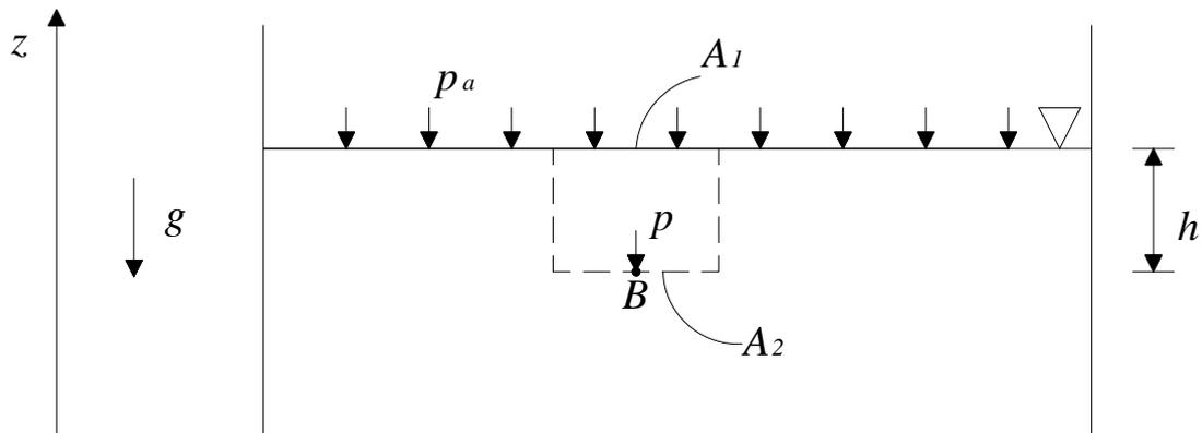
Si scelga come volume di controllo un cilindro con area di base pari ad  $A$  ( $A=A_1=A_2$ ) ed altezza  $h$ . L'equazione di bilancio della quantità di moto estesa a tale volume di controllo è espressa dalla:
