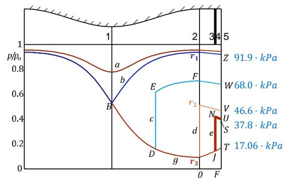
Si ripete il procedimento per un altro valore di  $L_{23}/D$  ( $L_{23}/D = 6$ ), dopodiché si procede con il metodo di falsa posizione.
