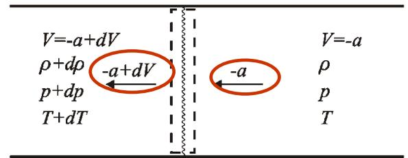
Per fermare l'onda, occorre dare a tutto il sistema una **velocità  $-a$**  e cioè muoversi con l'onda.
