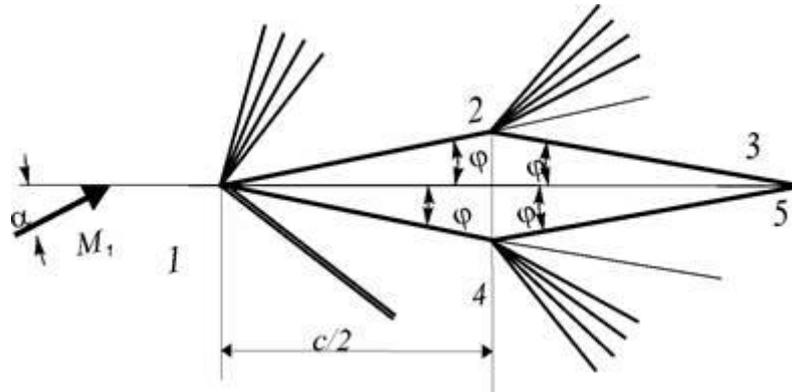
Sia dato il profilo a diamante rappresentato in figura, investito da una corrente d'aria supersonica ( $\gamma = 1.4$ ,  $M_1 = 3$ ). Siano noti l'angolo d'attacco  $\alpha = 6^\circ$ . Calcolare i coefficienti di portanza e resistenza del profilo. L'angolo  $\varphi$  è di  $4^\circ$ .
