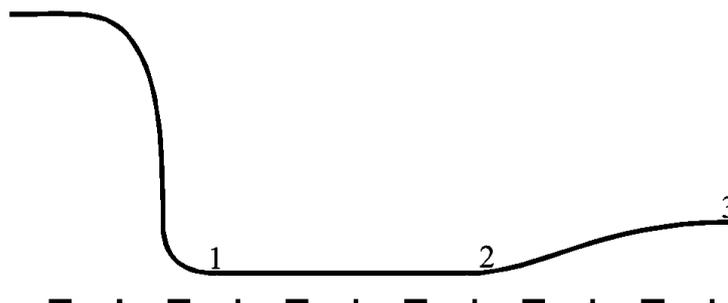
$Q_{12} = 109$  poichè il flusso imposto è nullo il sistema si riduce ad un semplice ugello convergente-divergente. Supponendo che il moto sia strozzato nella sezione 1 (o 2), dal rapporto delle aree, si può calcolare il numero di Mach nella sezione d'uscita e da questo gli altri parametri caratteristici.
