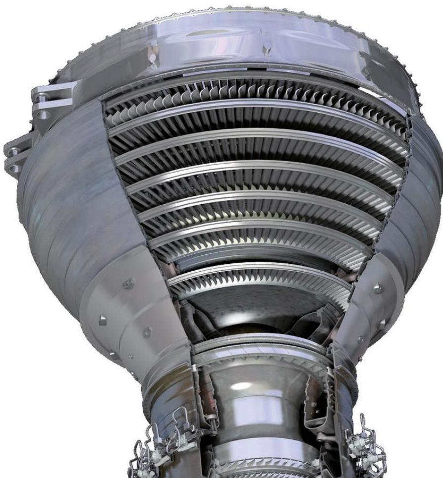
Trent 1000 (787). Peso 6000kg,  $L=4.7m$ ,  $D=2.85m$ ,  $F_{max}=300kN$ ,  $\dot{m}_a=1100kg/s$ ,  $\alpha=10$ ,  $\pi_c=50$ , Comp 1/8/6, Turb 1/1/6.
