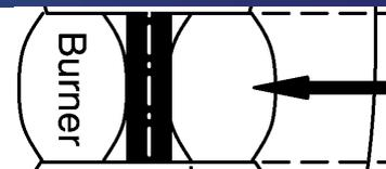
La temperatura limite  $T_{t4}$  è funzione della tecnologia di **raffreddamento** utilizzata e tipici valori sono del ordine di **1,750-2,000K**.
