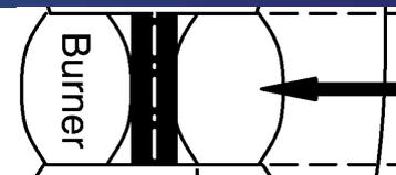
In realtà a causa degli attriti, del miscelamento turbolento e delle reazioni chimiche ad un numero di Mach basso ma diverso da zero il processo porta ad una **caduta** della **pressione di ristagno**.
