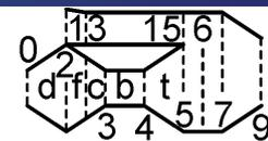
Il flusso secondario può essere **miscelato** a valle in un mixer oppure si può avere anche un motore a **flussi separati**.
