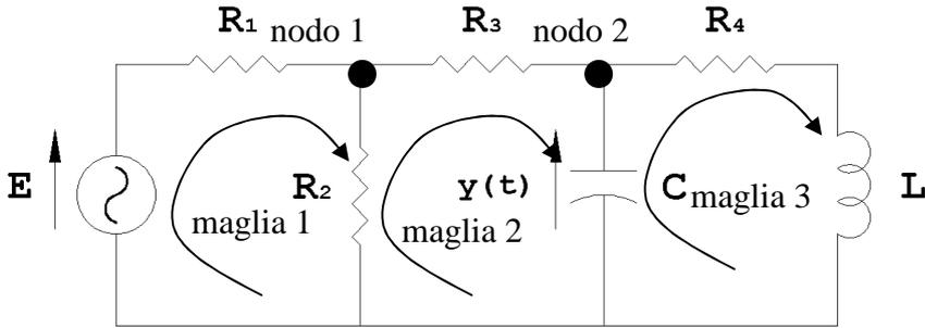
equazioni di stato del capacitore C:  $V_C = x_1$ ;  $i_C = C\dot{x}_1$ ;
