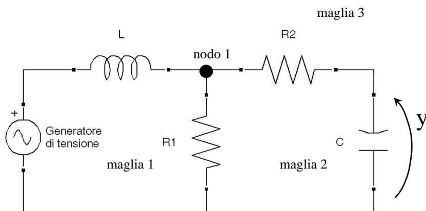
equazioni di stato dell'induttore:  $i_L = x_1$ ;  $V_L = L\dot{x}_1$ ;
