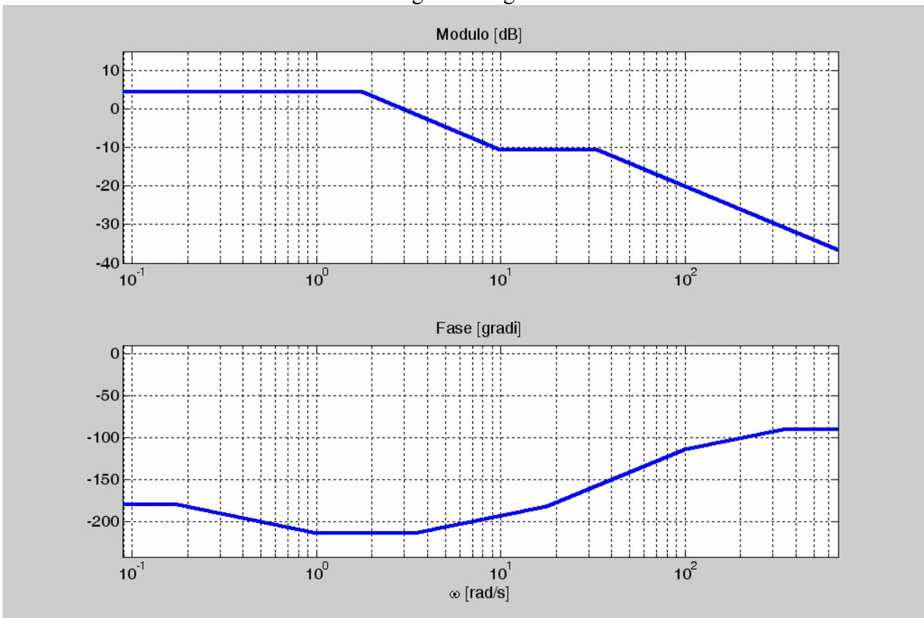
Si noti che il diagramma delle fasi parte da  $-180^\circ$ , essendo il  $K$  negativo, e che il polo a parte reale positiva dà un contributo positivo alla fase.
