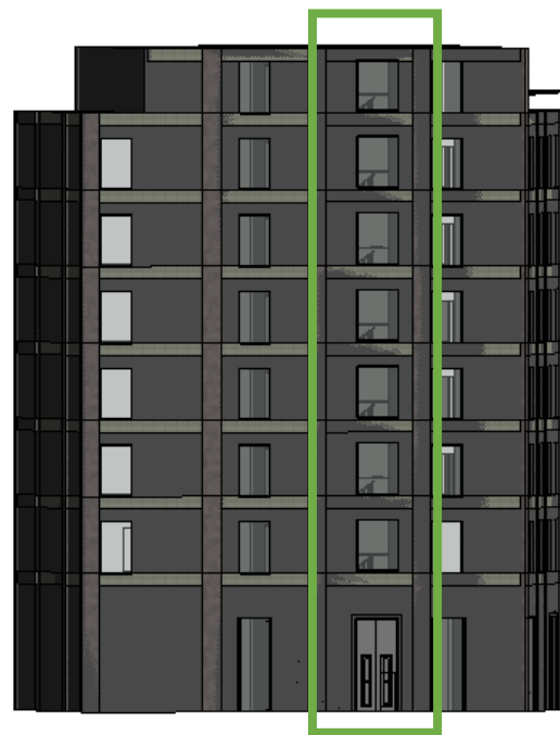
Eliminazione finestre coincidenti con pilastrata ed aumento di dimensioni di quella adiacente
