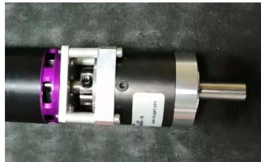
(d) Electric motor Lehner 2280/40 LK with Neugart PLE 40 gear box (4:1)
