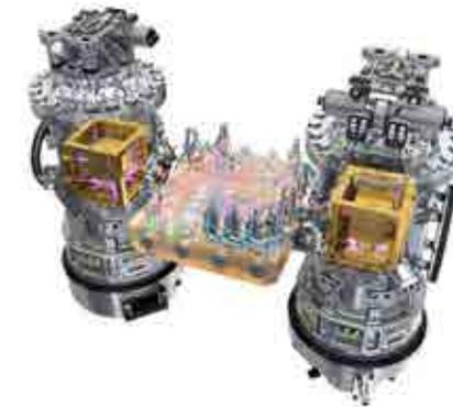
Principio di misura: risposta dinamica di un sistema **instabile** di masse in **volo libero**, isolate da **forze** ( $\text{PSD} < 3 \times 10^{-15} \text{ m/s}^2/\sqrt{\text{Hz}}$ ,  $10^{-4} \div 10^{-1} \text{ Hz}$ )
