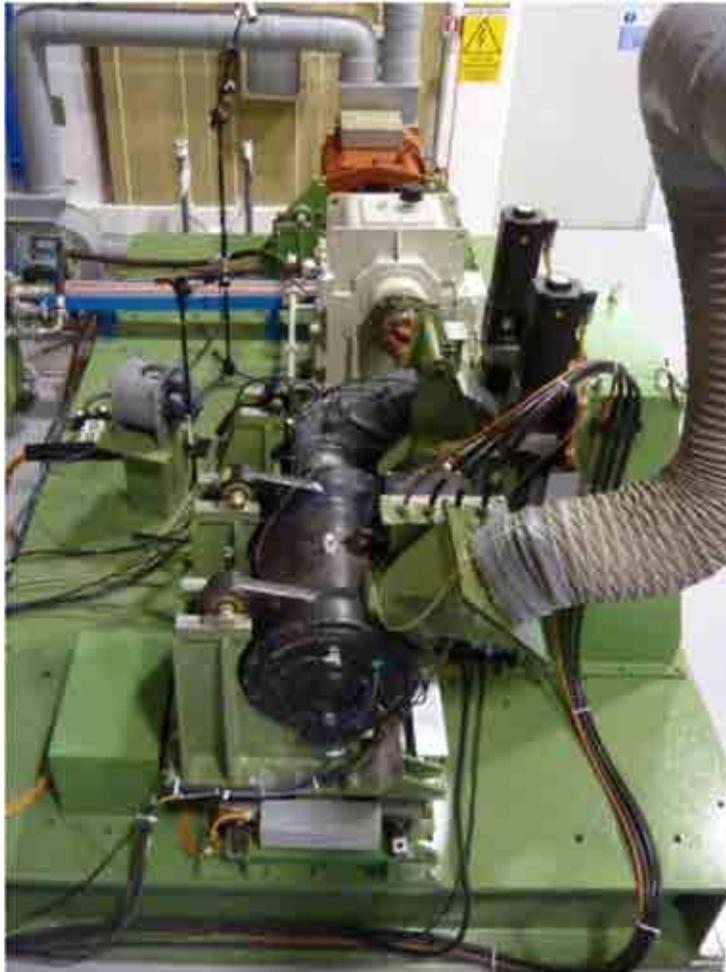
Banco prova motore-riduttore 300kW
