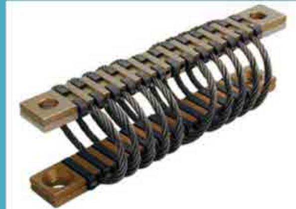
Molle a fune d'acciaio: economiche, senza manutenzione, dotate di smorzamento intrinseco, resistenti alle azioni ambientali, capaci di grandi deformazioni
