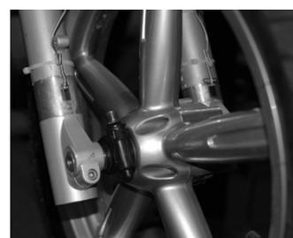
**Fig. 3 Foderi strumentati**
