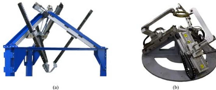
**Fig. 1 – (a) I.Car.Ro.: robot 3-CPU di pura traslazione; (b) Sphe.I.Ro.: polso sferico 3-CPU.**
