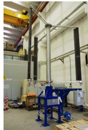
**Fig. 1 – Prove in galleria del vento sulla macchina ad asse orizzontale e VAWT H-Darrieus con IPC**
