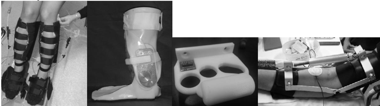
**Fig. 1- a) prove cliniche con prototipo IPC; b) HAFO con giunto flottante; c) particolare per il dispositivo di perturbazione della postura; d) ortesi strumentata di gomito**
