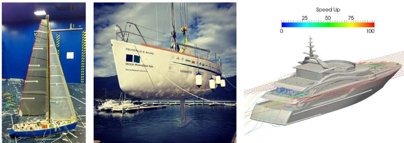
**Fig. 1 – Prove in galleria del vento (sinistra), Sailing Yacht Lab (centro) analisi numerica su mega yacht (destra)**
