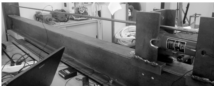
Fig. 1: La catena a cricca artificiale sull'impianto sperimentale.
