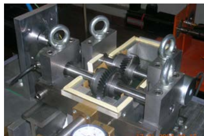
Fig. 2 -Banco sperimentale per analisi sul Gear Rattle
