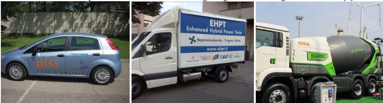
**Fig. 1 – Esempi di mezzi realizzati: autoveicolo ibrido parallelo per il trasporto persone, veicolo per il trasporto merci e macchina operatrice per il trasporto calcestruzzo**
