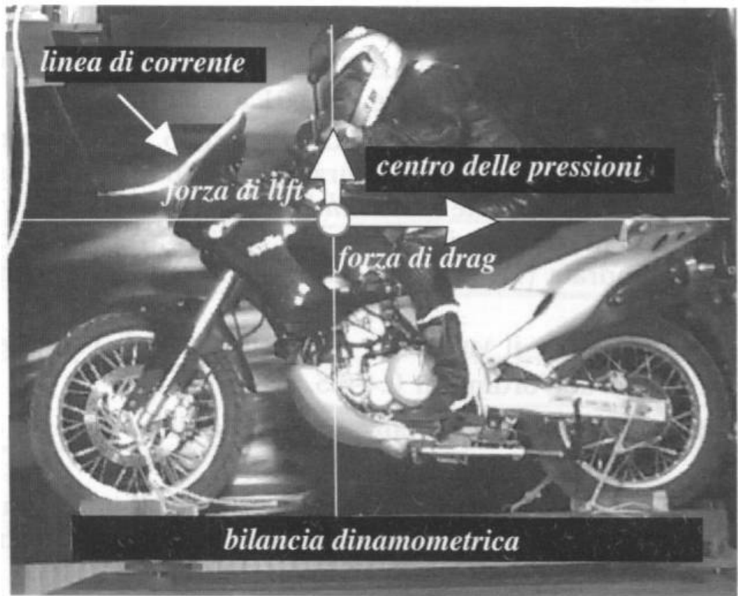
Fig 1.11. Linee di corrente attorno al cupolino ed al pilota (Galleria del vento dell'Università di Perugia)
