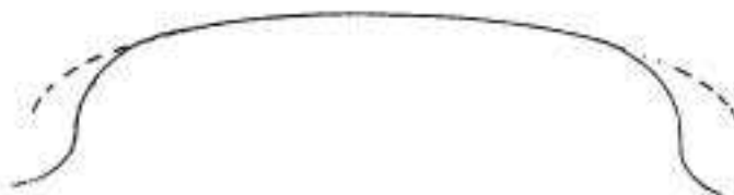
Figura 4.21: Schema del carico aerodinamico in crociera per l'ala del Boeing 747
