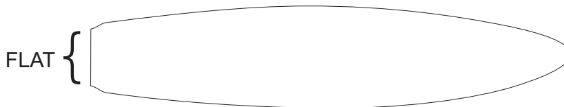
Figura 5.2: Geometria non trattabile aerodinamicamente con singolarità interne
