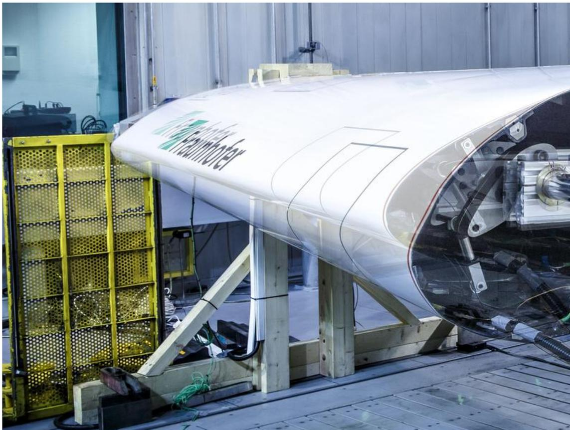
**Figura 9.** *Droop nose* progettato e prodotto da Fraunhofer Institute for Structural Durability and System Reliability LBF in Darmstadt in occasione del programma *Clean Sky - Green Regional Aircraft del 2015*.
