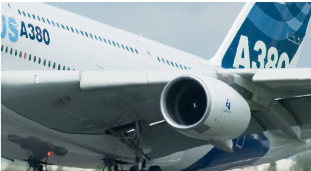
**Figure 2,3.** Volo dimostrativo del MSN001(*Manufacturer's Serial Number 001* ) al [Salone di Le Bourget](#) nel 2007.Ingrandimento dell'A380 in prossimità del bordo d'attacco dell'ala al fine di visualizzare la deflessione del *Droop nose* in fase di decollo.
