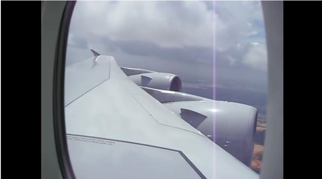
**Figure 4,5,6,7,8.** Fase di decollo di un Airbus A380. Lo scopo delle immagini è quello di mostrare che l'A380 deflette il *Droop nose* a partire dalla fase di decollo fino all'inizio della crociera.
