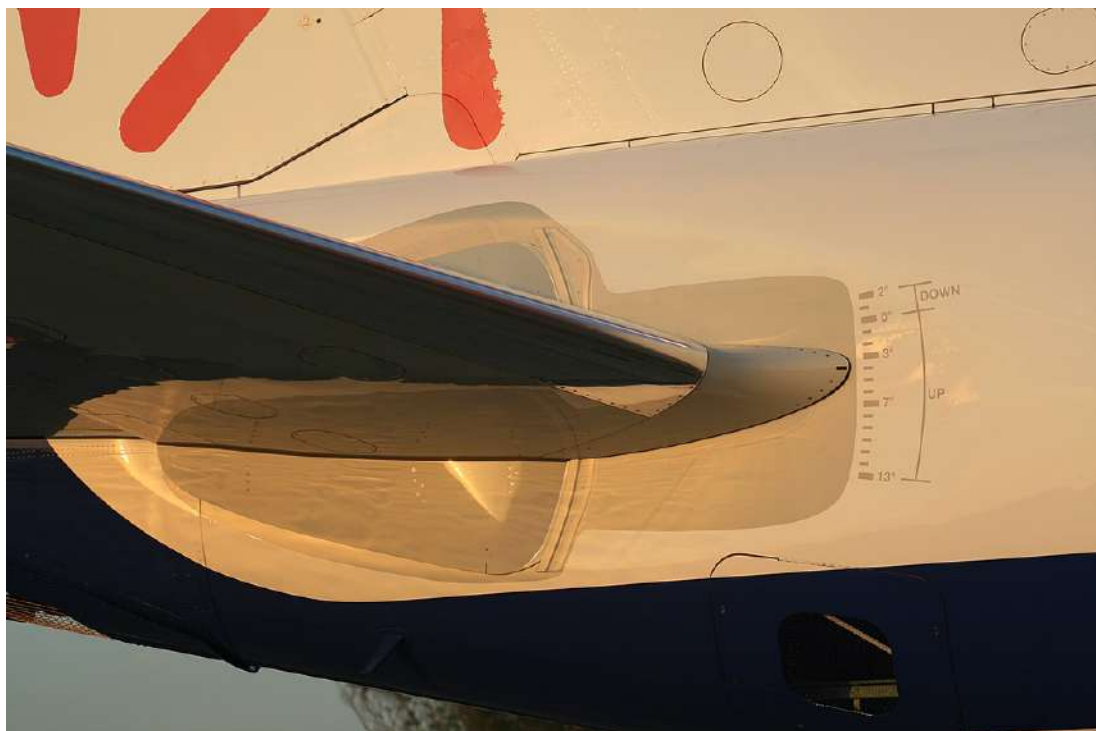
Figura 3.3: Rappresentazione dello stabilizzatore del velivolo Embraer ERJ-170, [8]
