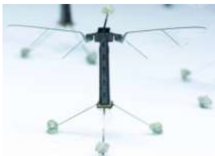
Figura 3.1.2: Ape robotica sviluppata dall'università di Harvard [21]
