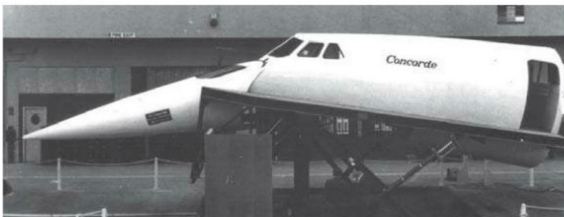
Figura 12: Range di inclinazione del droop nose. ( Crowood Aviation Series )
