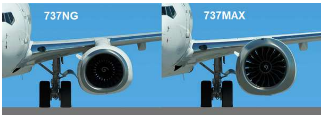
Figura 3.1: Confronto tra i motori CFM56 del Boeing 737NG e i motori CFM LEAP-1B del Boeing 737 MAX 8, [6]
