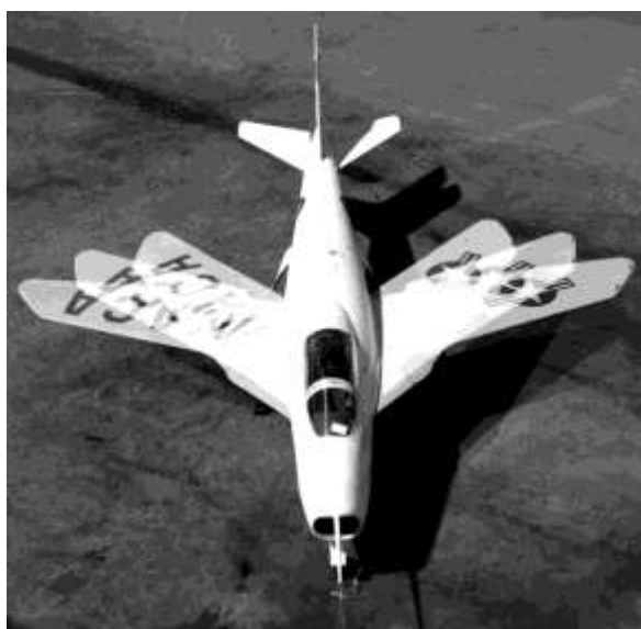
Figura 1.4: Foto a più esposizioni che mostra le differenti posizioni delle ali a geometria variabile [8]
