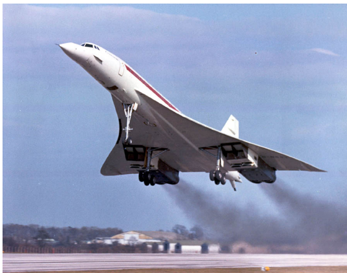
Figura 9: Il motore Olympus oltre ad essere estremamente rumoroso produceva anche una scia di fumo molto evidente durante la fase di decollo. In foto è raffigurato il prototipo britannico ‘Concorde 002’ soprannominato ‘ Smokey Joe ’. (Airbus)
