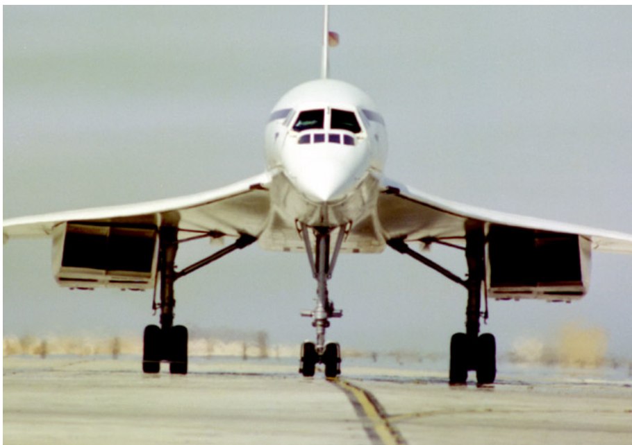
Figura 30: In questa vista frontale del Concorde è possibile osservare come le prese d'aria siano rivolte verso il basso e ruotate verso la mezzeria del velivolo. ( Owners Workshop Manual - Concorde )
