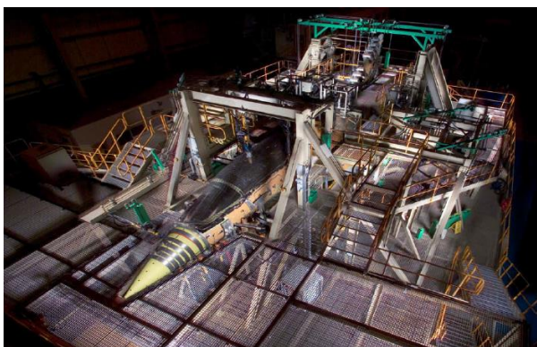
Figura 7 - Prova strutturale a terra dell'Eurofighter Typhoon
