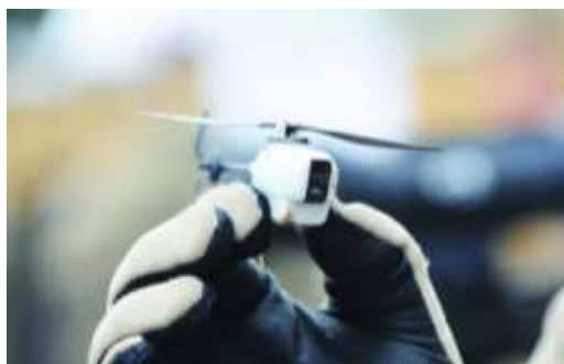
Figura 3.1.1: sviluppato da Prox Dynamics, The black hornet Nano Unmanned Air Vehicle è stato usato dalle truppe britanniche in Afghanistan [21]
