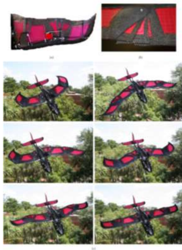
Figura 3.1.4: ulteriore esempio di morphing wing (realizzata in fibra di carbonio e nylon ripstop) in un MAV [27]
