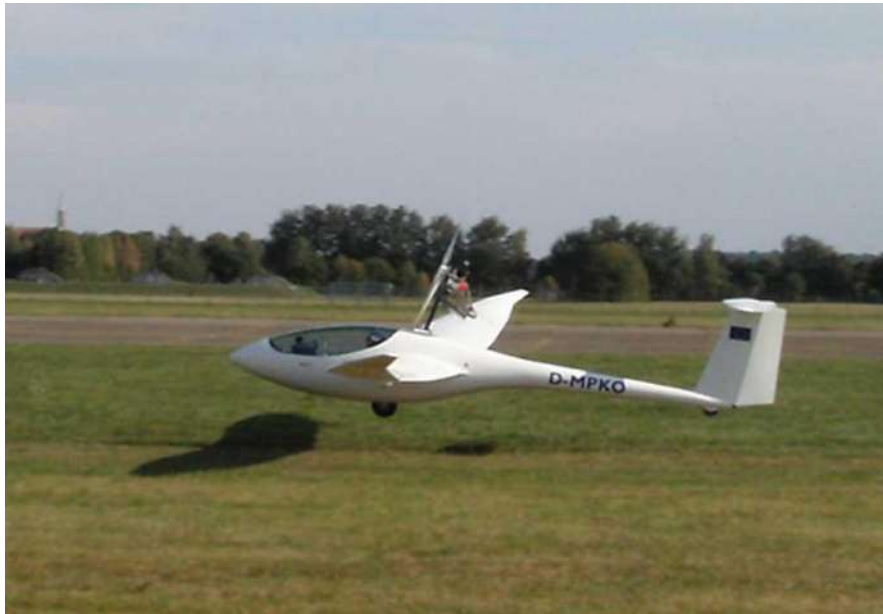
Figura 4.2 – Apis 2 in decollo, motoalante a motore retrattile
