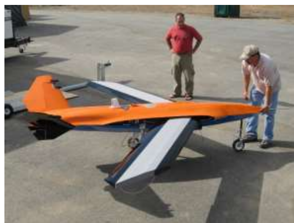
Figura 3.2: MFX-2 della NextGen Aeronautics. Le aree grigie sulle ali sono i pannelli capaci di cambiare forma [19].
