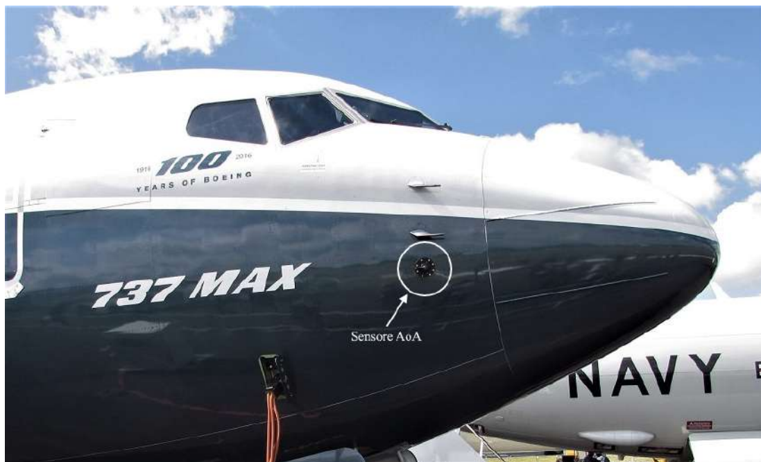
Figura 3.2: Rappresentazione del sensore destro dell'angolo d'attacco del velivolo Boeing 737 MAX
