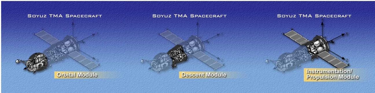
**Figura 6.1** Nell'ordine: *Orbital Module*, *Descent Module*, *Instrumentation/Propulsione Module*
