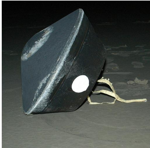
**Figura 2.5** Capsula di rientro della sonda *Stardust*.
