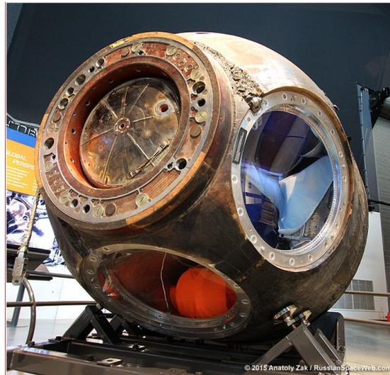
Figura 6.3 Il Descent Module dopo l'atterraggio.
