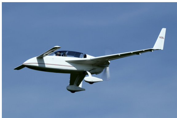
Figura 2: Il velivolo VariEze. Sono visibili le alette canard, le winglet e l'elica in configurazione spingente.
