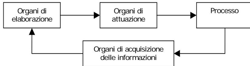
**Figura 1.4** Struttura base di un sistema di automazione elementare
