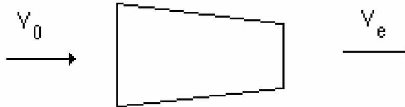
$$T = \dot{m} (V_e - V_0) + \dot{m}_f V_e + A_e (p_e - p_0)$$
