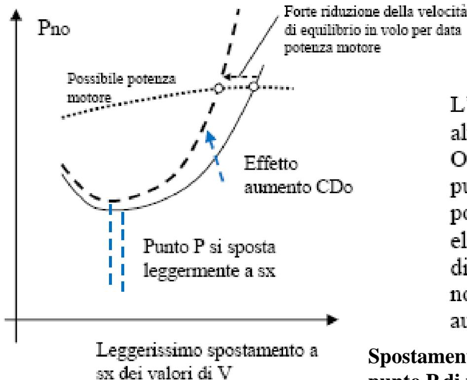
L'aumento del CDo si fa sentire soprattutto alle alte velocità sulla potenza necessaria al volo. Ovviamente non fa variare molto le velocità dei punti caratteristici (come prima) Per data potenza disponibile (ad esempio un velivolo ad elica) si vede come è drammatica la riduzione di velocità derivante da un aumento di CDo, ma non molto sensibile la riduzione dovuta ad aumento di peso. (vedi pagina precedente)
