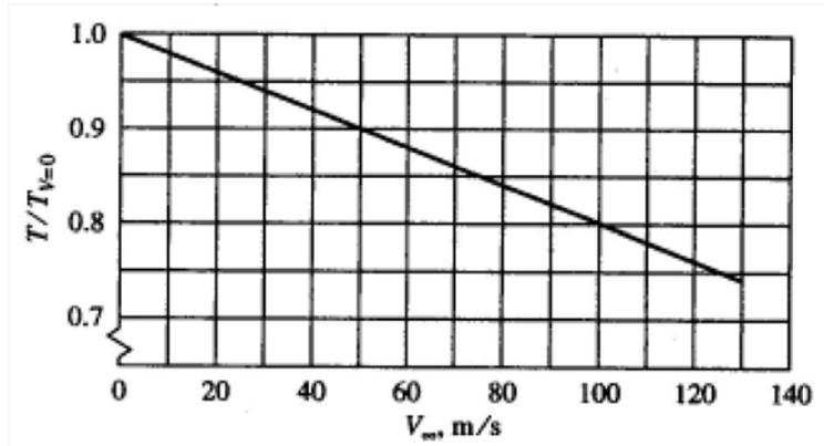
$$KT := 1 - 0.20 \cdot \frac{V}{100 \cdot \frac{m}{s}} \quad KT = 0.92 \quad \text{Fattore di riduzione spinta in decollo motore turbofan}$$
