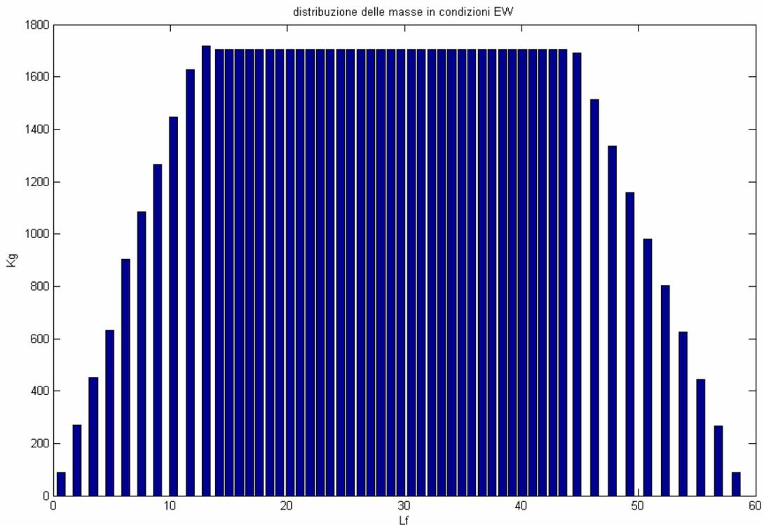
Analogamente, aggiungendo ai tronchi di cabina la massa di dieci passeggeri completi di bagaglio ed alle sezioni più arretrate del tronco frontale la massa del personale di volo, possiamo ottenere il baricentro della fusoliera a pieno carico, che coinciderà col baricentro del velivolo
