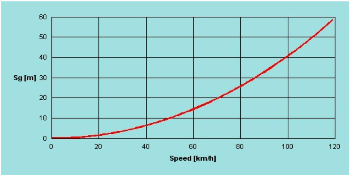
Figura 5. 46 – Diagramma della corsa al suolo in funzione della velocità.
