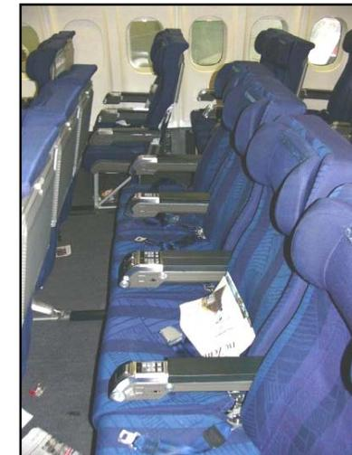
Un velivolo durante la sua vita operativa tipicamente sottosta ad un numero di riconfigurazioni del suo allestimento interno. Quindi deve essere fornita la possibilità di riconfigurare facilmente il numero di posti per classe e/o il numero di classi in una stessa stagione.
