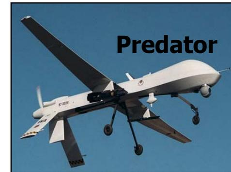
Specialmente quando il velivolo deve essere progettato per operare per la maggior parte della missione ad alti valori del coefficiente di portanza, il solo modo di ottenere prestazioni ragionevoli di autonomia di durata e di distanza è di usare il più alto allungamento possibile per ridurre la resistenza indotta.
