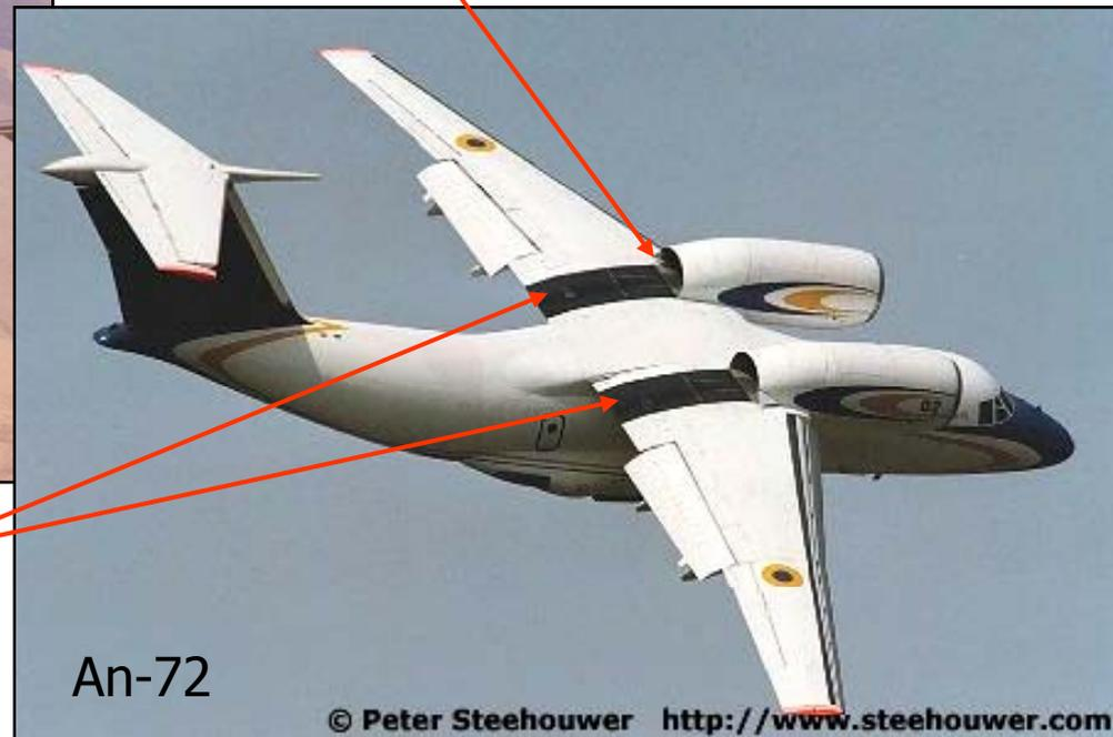
Questo tipo di architetture è implementato quando il valore del  $CL_{max}$  richiesto **supera 3.5 - 4**, che può essere considerato un limite superiore per i sistemi convenzionali di ipersostentazione
