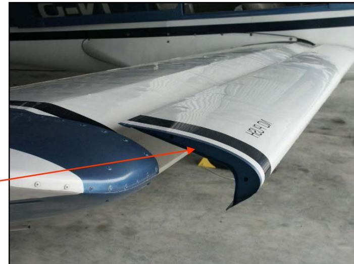
Questo è il dispositivo di ipersostentazione del bordo di attacco più efficace. Contribuisce ad aumentare  $CL_{max}$  e a fornire un incremento dell'angolo di stallo.
