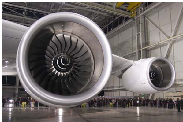
Figura 6.3 – Motore Rolls-Royce Trent 900 dell'Airbus A380-800.
