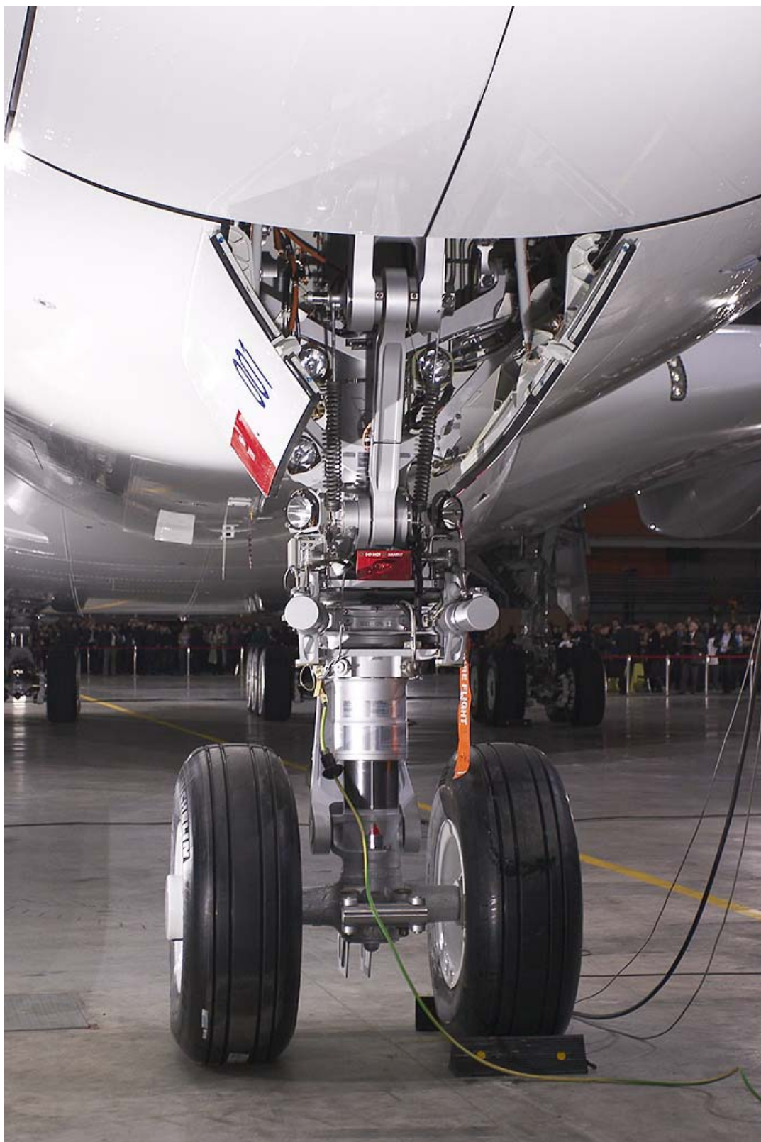
Figura 6.6 – Particolare del carrello dell'Airbus A380-800.
