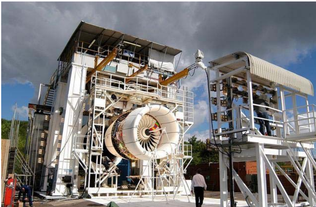
Figura 7.10 – Trent 900 durante la fase delle prove al banco.
