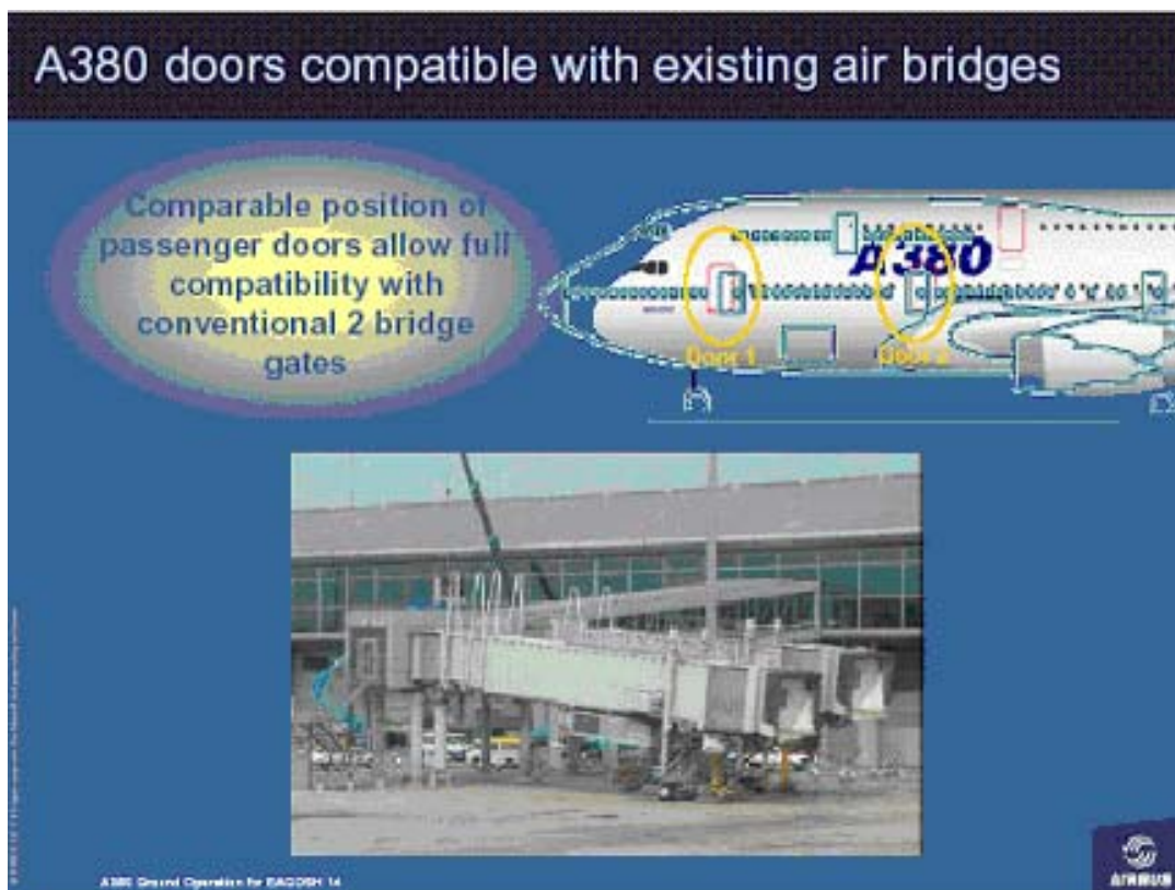
Figura 5.41 – Compatibilità dell'A380 con gli aeroporti esistenti attraverso il confronto con il B747 (Airbus).
