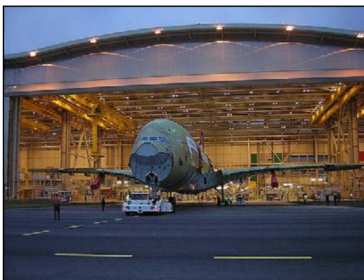
Figura 1.16 – A380 in fase di assemblaggio a Tolosa.
