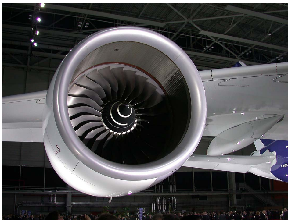
Figura 7.1 – Uno dei quattro motori turbofan, da 70.000 libbre di spinta, che equipaggiano l'A380-800.
