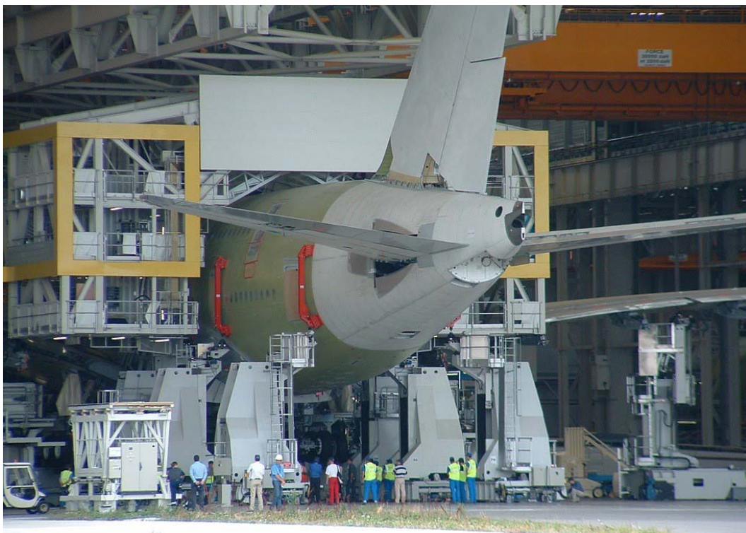
Figura 6.14 – Particolare della coda dell'A380-800 in fase di costruzione negli stabilimenti Airbus di Tolosa.
