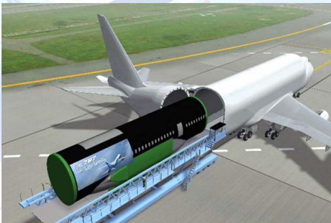
Fig.6 : Fasi del processo di trasporto della fusoliera del Boeing 787.
