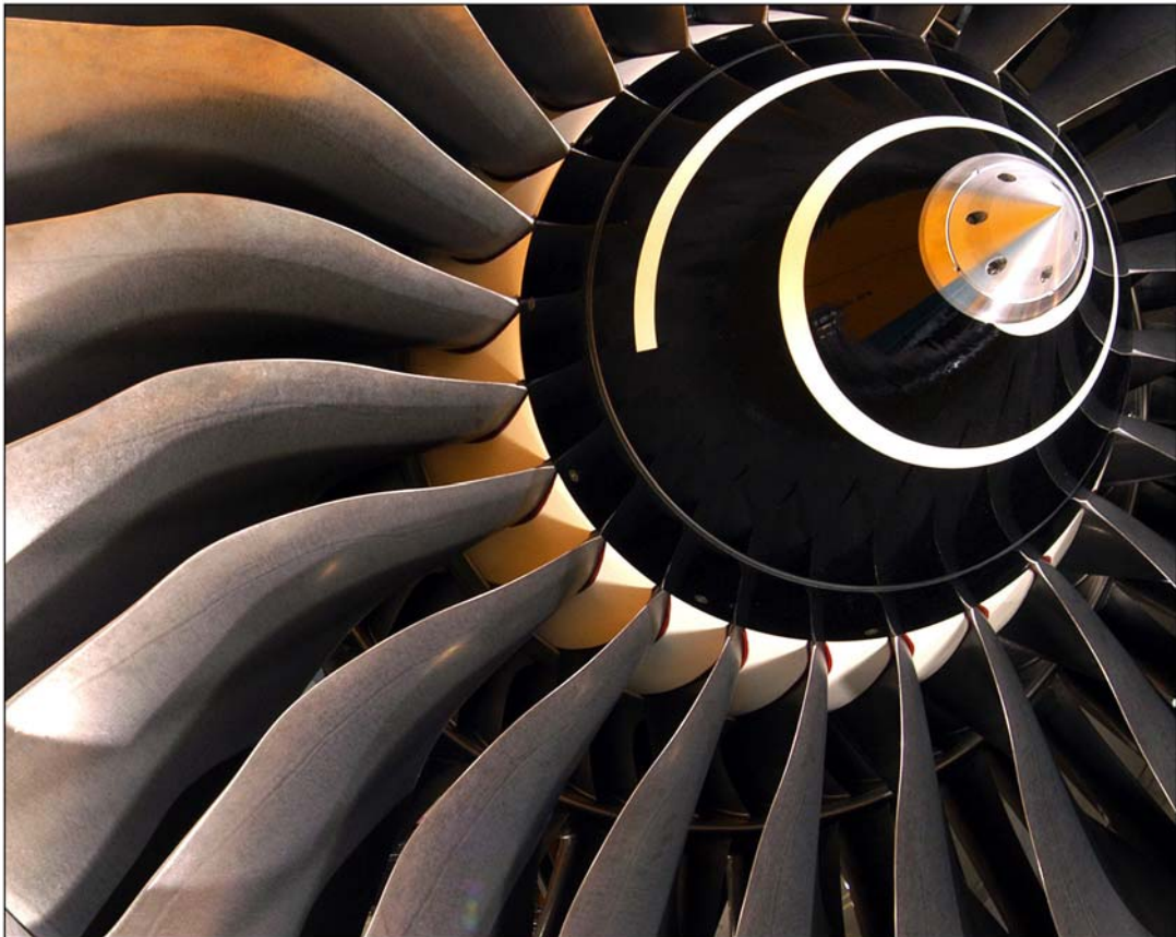
Figura 7.9 – Fan del Trent 900.
