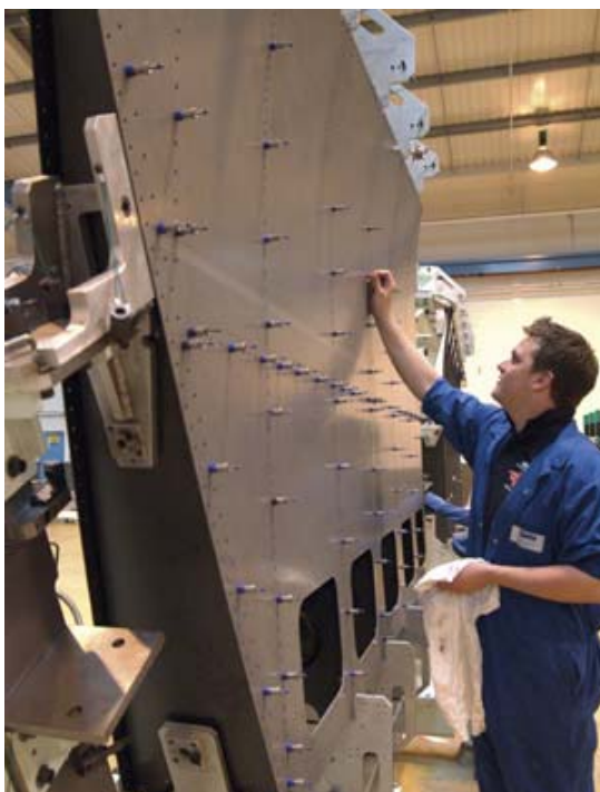
Figura 4.46 –Particolare della fase di rivettatura dell'ala.
