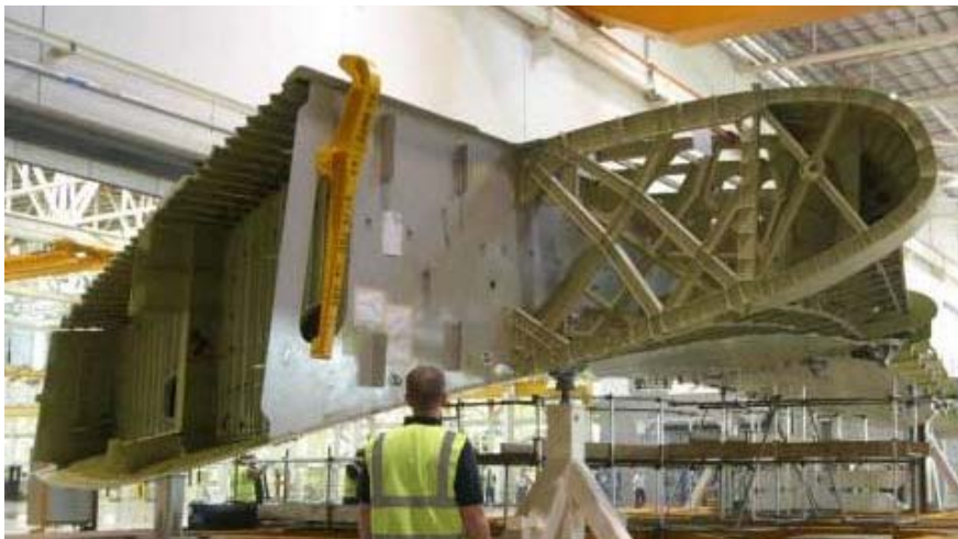
Figura 9.13 – Semiala dell'Airbus A380-800 in costruzione.
