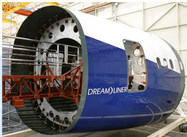
Fig.13 : Parti di fusoliera nella fase di assemblaggio finale.
