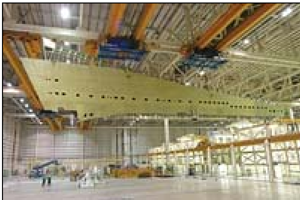
Figura 4.1 – Semiala dell'Airbus A380-800 in fase di costruzione.
