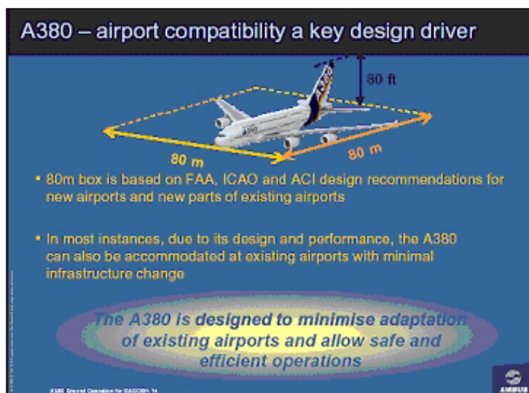
Figura 4.3 – Compatibilità dell'A380-800 con le strutture aeroportuali esistenti. (Airbus)
