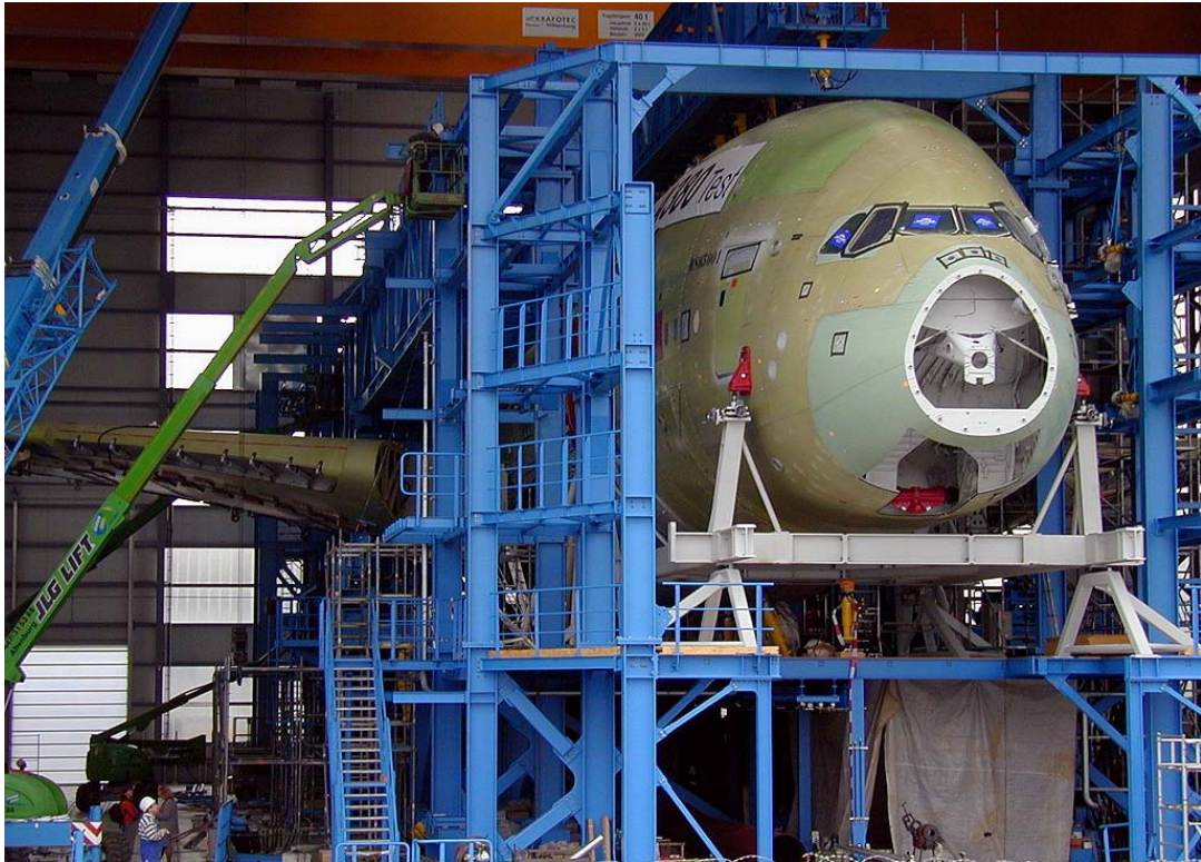
Figura 9.8 Particolare del muso dell'A380-800 in costruzione.
