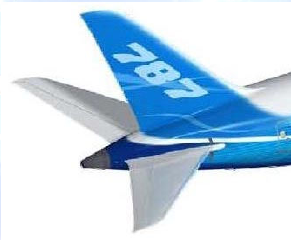
Fig. 2 : Impennaggio orizzontale e verticale del Boeing 787.
