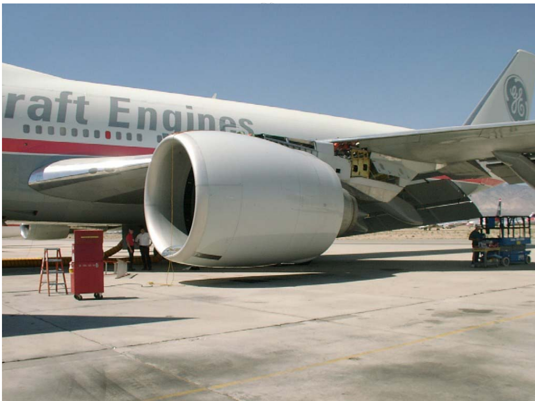
Figura 7.4 – Il motore turbofan GP7270 montato a bordo del Boeing B747-400 per le prove di volo.
