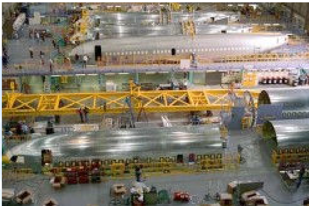
Fig.11 : Scali per la costruzione di tronchi di fusoliera.
