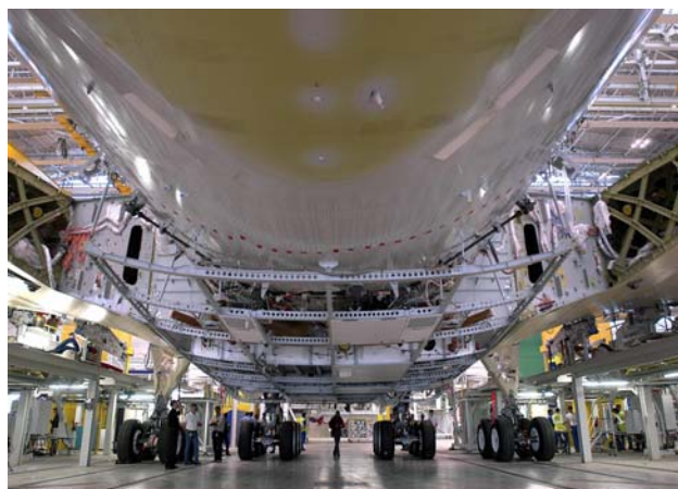
Figura 6.4 – Carrello posteriore dell'Airbus A380-800.
