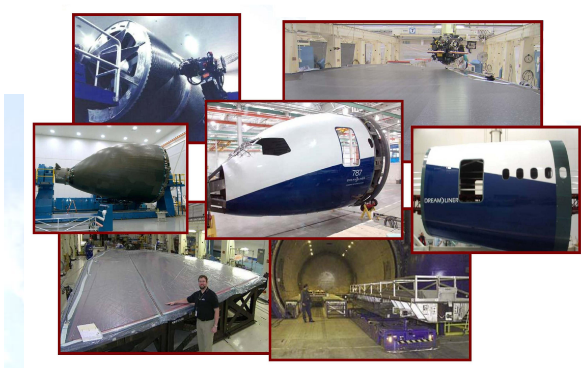
Fig.10 : Parti di fusoliera da assemblare del Boeing 787.
