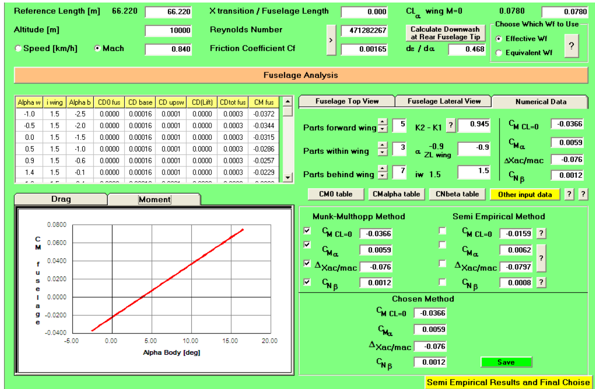
Figura 5.9: analisi della fusoliera con il metodo di Munk
