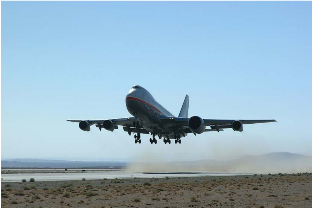
Figura 7.5 – Il motore turbofan GP7270 montato a bordo del Boeing B747-400 per le prove di volo.
