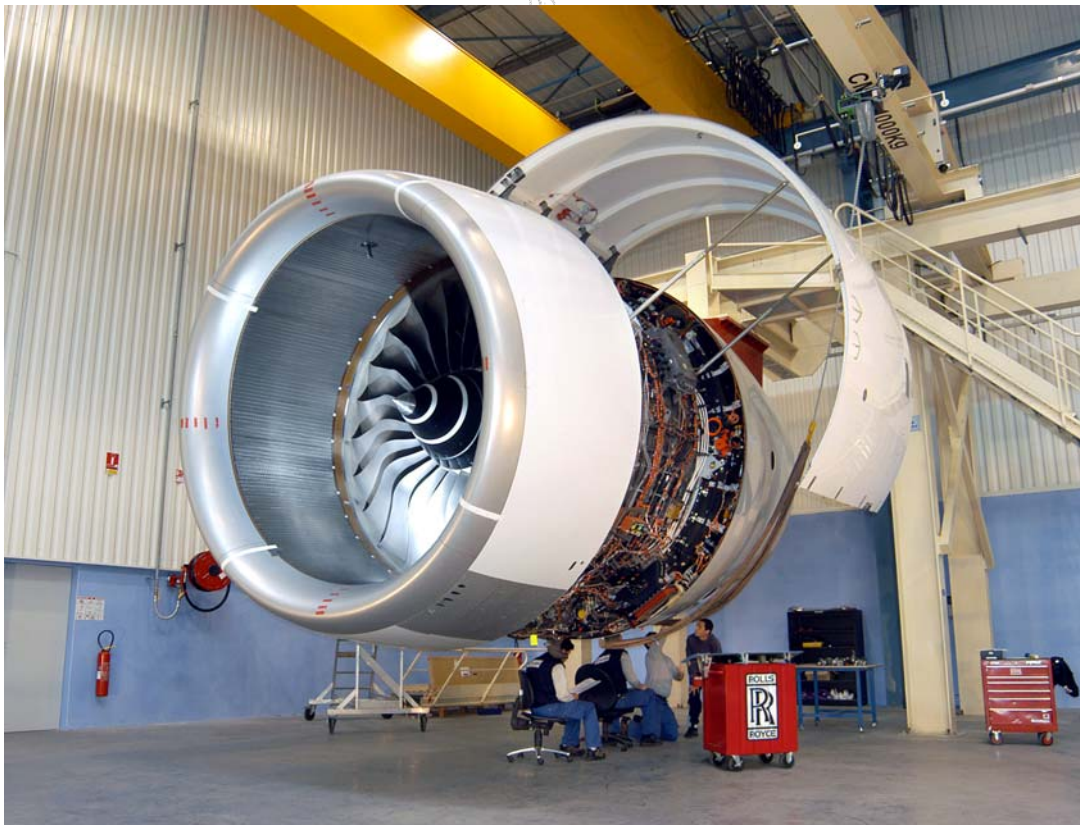
Figura 7.28 – Turbofan Trent 900 in fase di messa a punto.
