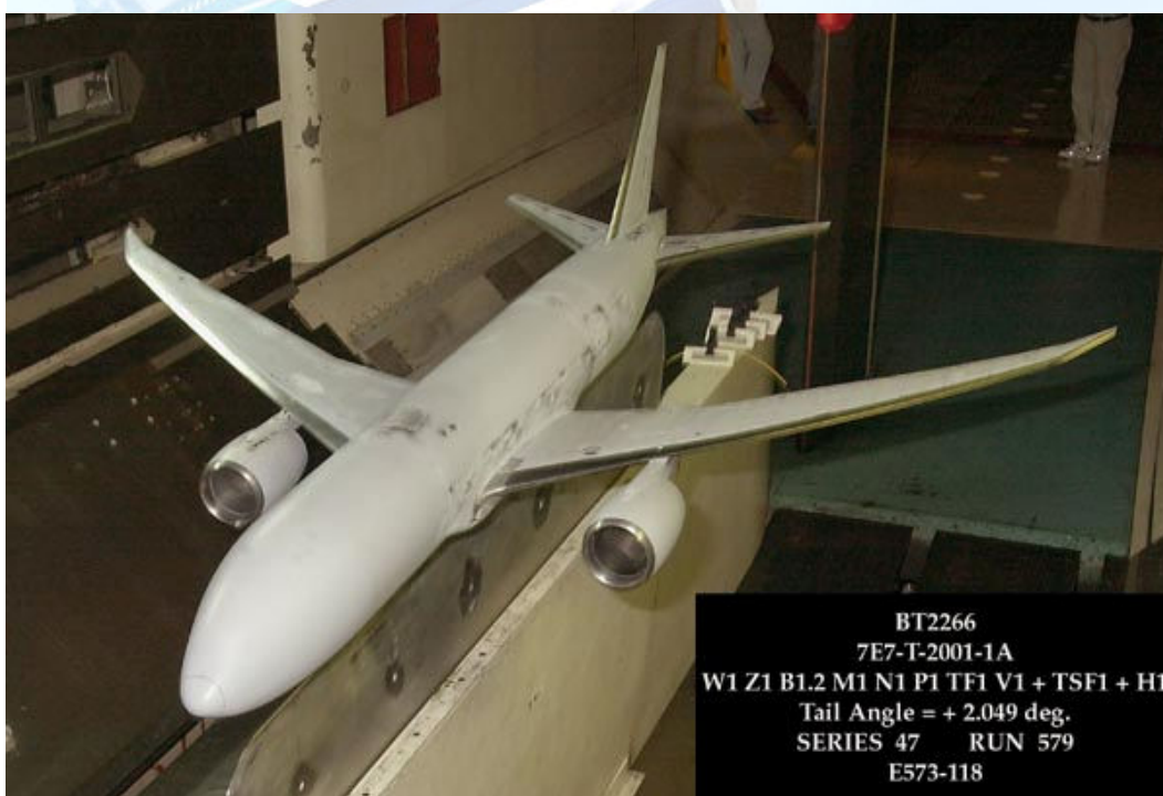
Fig.13 : Aeromodello del Boeing B787 per prove in galleria aerodinamica.
