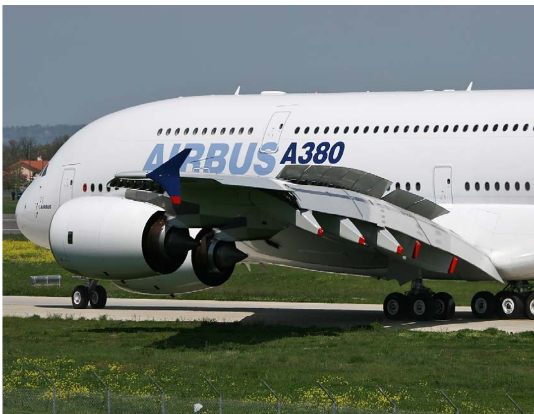
Figura 6.37 – Sistema di ipersostentazione dell'Airus A380-800.
