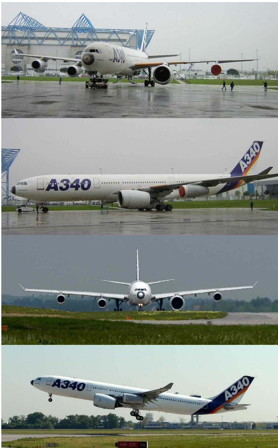
Figura 7.3 – Il motore turbofan Rolls Royce Trent 900 montato a bordo dell'Airbus A340 per le prove di volo.
