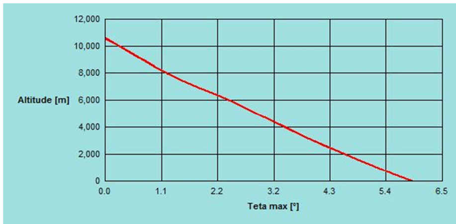
Fig. 62 – Diagramma dell'angolo di salita massimo in funzione della quota
