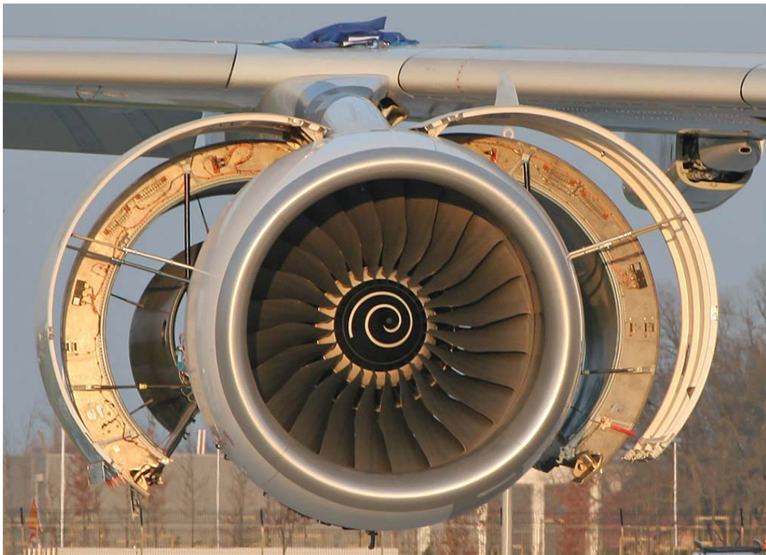
Figura 7.27 – Turbofan Trent 900 in fase di messa a punto.
