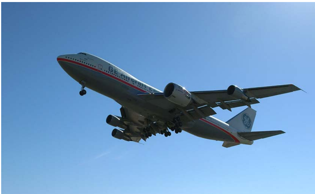
Figura 7.6 – Il motore turbofan GP7270 montato a bordo del Boeing B747-400 per le prove di volo.
