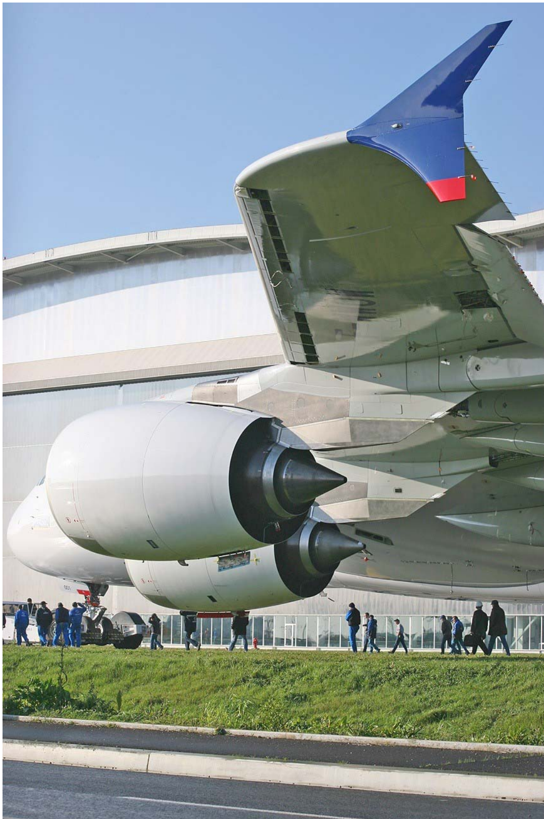
Figura 7.14 – Particolare dei motori montati nella parte inferiore della semiala sinistra dell'A380-800.
