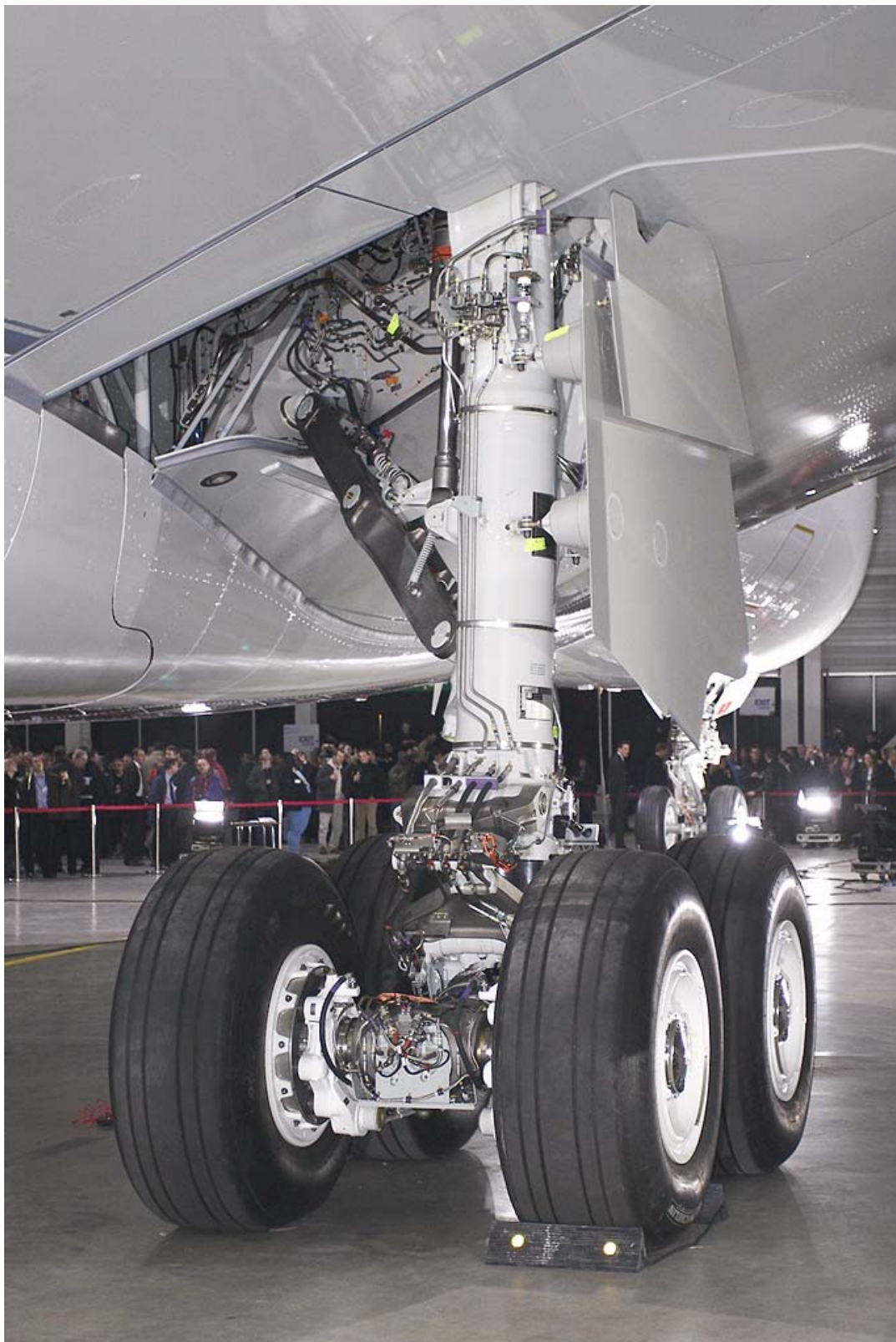
Figura 6.7 – Particolare del carrello dell'Airbus A380-800.
