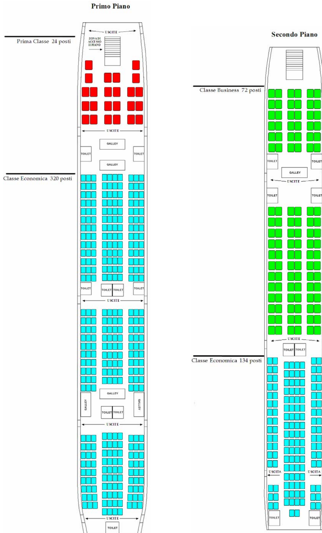
Fig. 6 Caratteristiche interne della fusoliera, primo e secondo piano
