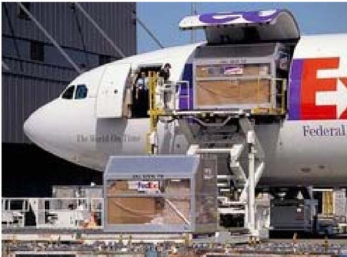
Velivoli da trasporto merci che operano su aeroporti preparati ed organizzati non necessitano di un piano del pavimento basso per facilitare le operazioni di carico.
