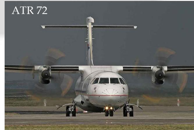
La posizione del motore ad elica deve tenere conto della distanza da terra, ma anche della distanza dalla fusoliera.
