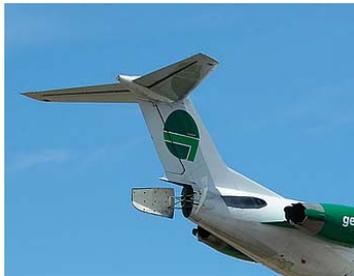
**Coda a T:** è in effetti una soluzione molto popolare. Il piano orizzontale gioca un ruolo simile a quello delle *winglet* sulle ali (*end plates*), cioè accresce l'allungamento effettivo del piano verticale (riducendo la resistenza indotta dalla portanza). Il piano orizzontale resta ben al di fuori della scia dell'ala e dei flussi dei motori. Il piano verticale deve sopportare anche il carico del piano orizzontale (ciò può portare ad una struttura più pesante).
