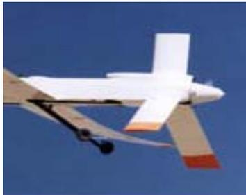
**(Inverted) Y-tail:** simile in parte al concetto del V-tail, ma una piccola superficie verticale è mantenuta per il controllo direzionale. Sono necessari carrelli lunghi. Sull'F-4 l'impennaggio ad Y invertito è stato usato per mantenere i piani orizzontali fuori della scia dell'ala ad alti angoli d'attacco.
