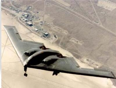
**Ala volante senza coda (Tailless flying wing):** la stabilità del velivolo può essere ottenuta attraverso un appropriato progetto della curvatura dei profili alari e posizionano con cura il baricentro. Generalmente un sistema di controllo assistito è necessario per rendere il velivolo stabile. Le winglet possono essere usate per il controllo direzionale. Il B2 non ha winglet ed usa un sistema a split flap.
