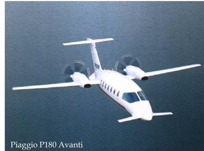
Configurazione ad ala media => normalmente possiede la minima resistenza aerodinamica (fondamentale per le prestazioni di velocità).
