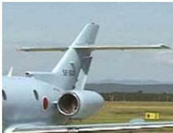
**Cruciform-tail:** un compromesso tra le due configurazioni precedenti. Piano orizzontale fuori delle scie, minore carico strutturale sul piano verticale. Solo una modesta riduzione della lunghezza del piano verticale dovuta all'incremento dell'AR per effetto *end plate*. Una parte del timone è libera dalla scia del piano orizzontale ad alti angoli d'attacco.
