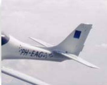
**Coda convenzionale:** è usata dalla maggioranza dei velivoli. I piani di coda orizzontali sono posti in vicinanza della linea di mezzeria del velivolo. Le funzioni di fornire controllo e stabilità longitudinale e direzionale sono separate e svolte da diversi elementi strutturali.
