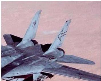
**Twin tail:** Configurazione tipica su velivoli da combattimento altamente manovrabili. Mantiene i piani verticali fuori della scia della fusoliera ad alti angoli d'attacco.
