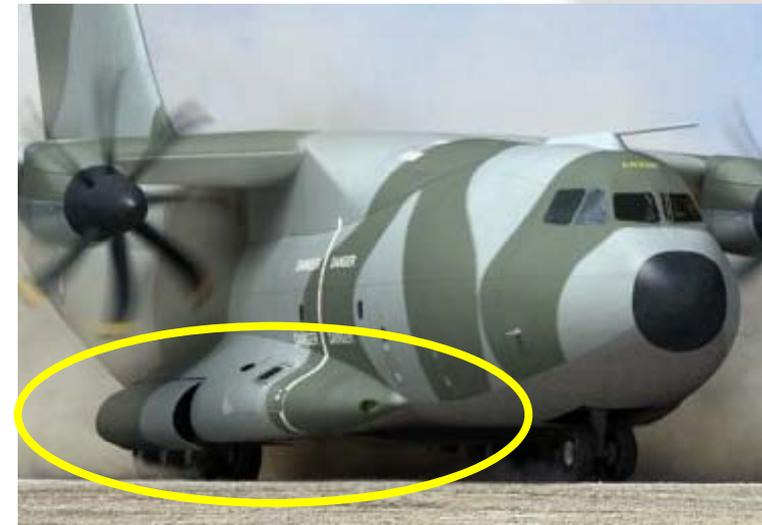
Carrelli montati in fusoliera => Diminuzione della carreggiata (distanza tra le unità destra e sinistra del carrello principale)
