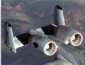
**H-tail:** le derive verticali restano completamente fuori dalla scia della fusoliera (alti angoli d'attacco, configurazioni *piggy back*, etc.). La lunghezza del piano orizzontale può essere ridotta grazie all'effetto *end plate* (soluzione strutturale più pesante). Sono possibili piani verticali più corti (vulnerabilità ridotta).
