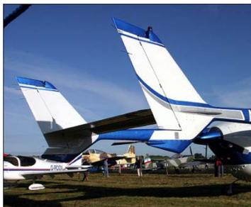
**Boom-mounted tail:** tipo di configurazione non convenzionale principalmente usato in combinazione con un motore ad elica spingente sulla linea di mezzzeria o in combinazione con una porta di accesso posteriore alla fusoliera
