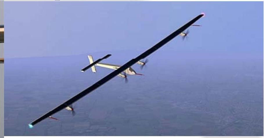
L'aeroplano ha un'[apertura alare](#) pari a quella di un [Airbus A340](#). Sotto l'ala vi sono quattro navicelle, ciascuna delle quali contiene un insieme di [accumulatori litio-polimero](#), un motore da 10 [HP](#) e un'elica a due pale. Per mantenere la sua caratteristica ultraleggera, si è utilizzata una struttura personalizzata a [nido d'ape](#), realizzata con un [sandwich di fibra di carbonio](#).<sup>[1]</sup>
