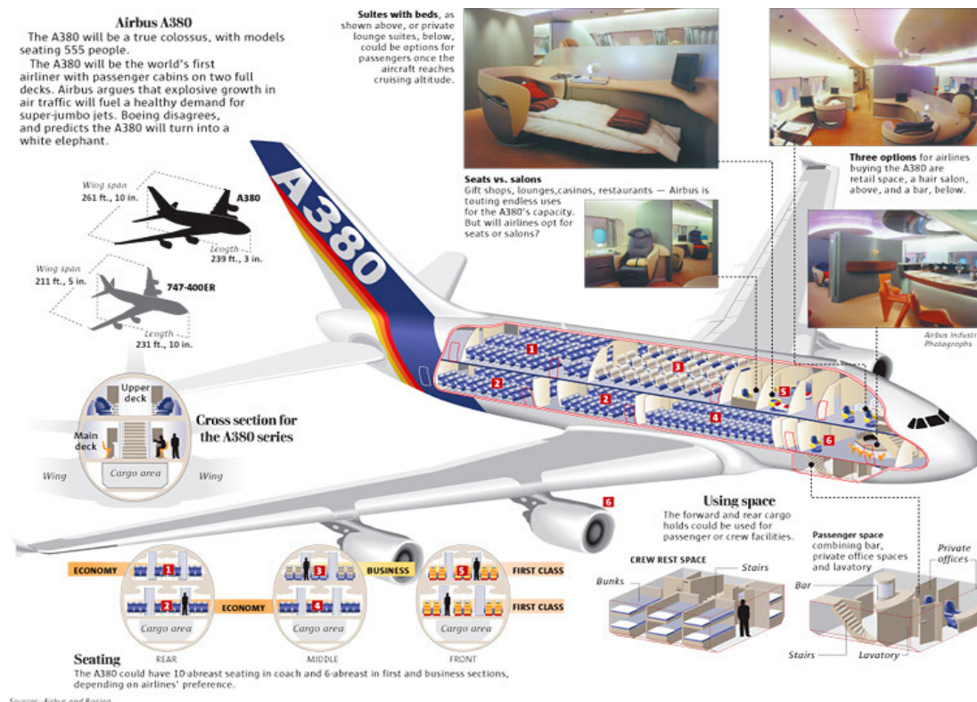
Figura 4.1 – Spaccato della fusoliera del velivolo da trasporto Airbus A380
