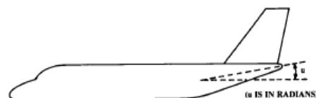
Figura 4.17 - Angolo di upsweep della fusoliera
