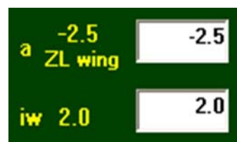
Figura 4.49 - Angolo di portanza nulla e calettamento dell'ala
