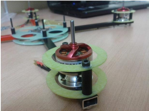
(a) Installazione delle protezioni per un motore
