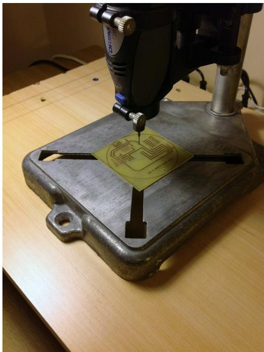
Figura 5.23: Processo di foratura
