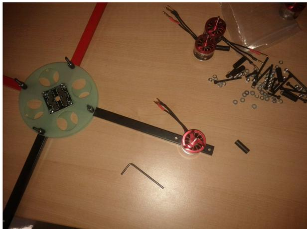
(b) Installazione di un motore
