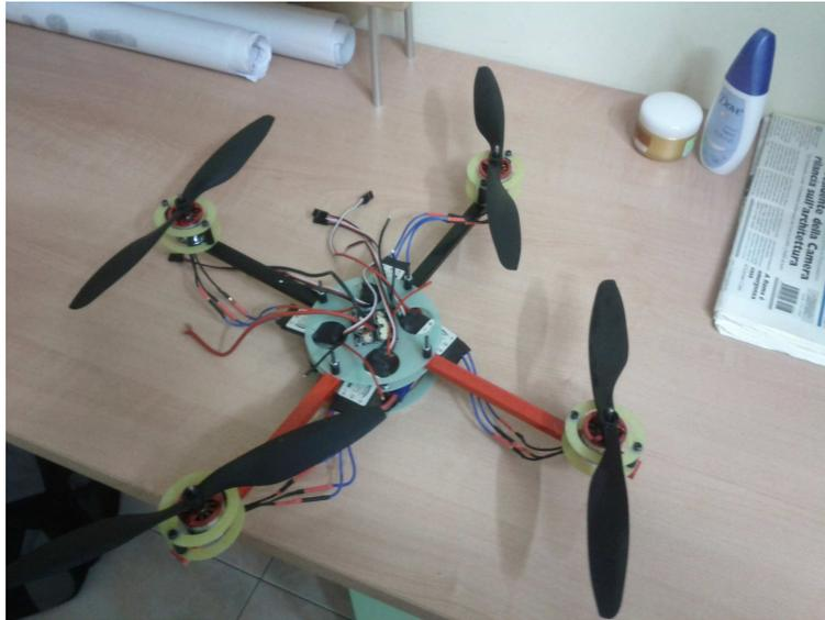
Figura 5.31: Quadcopter con eliche installate e senza elettronica di controllo
