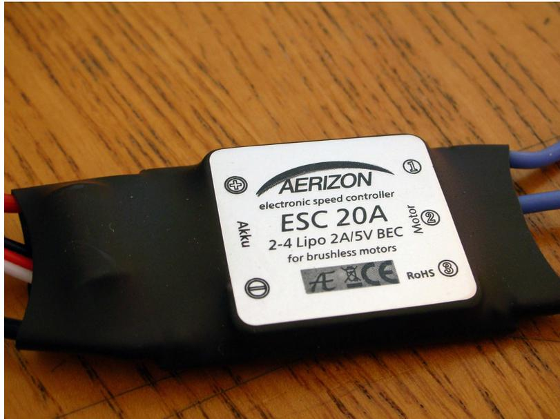
Figura 5.10: E.s.c. da 20A complessivi con sistema BEC
