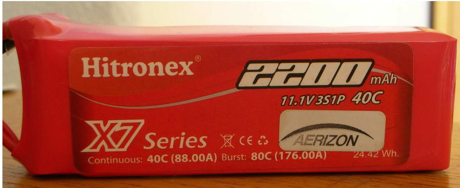
Figura 5.19: Batteria al Litio a celle da 11.1v
