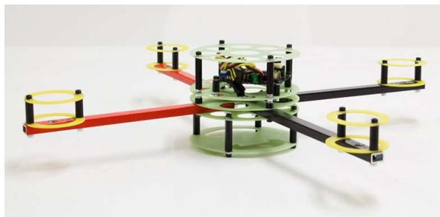
Figura 5.2: Il telaio Quad01 scelto per la realizzazione, dopo l'assemblaggio
