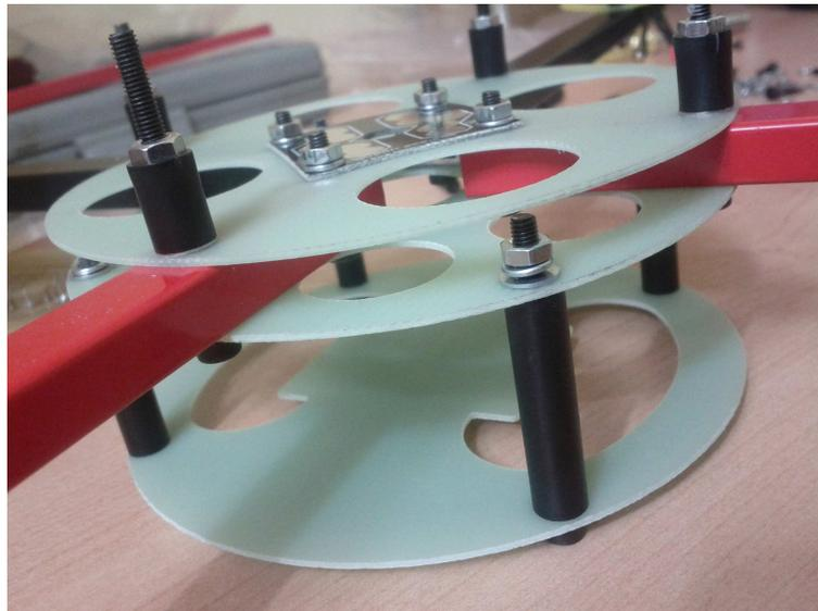
Figura 5.26: Particolare della torretta centrale del frame
