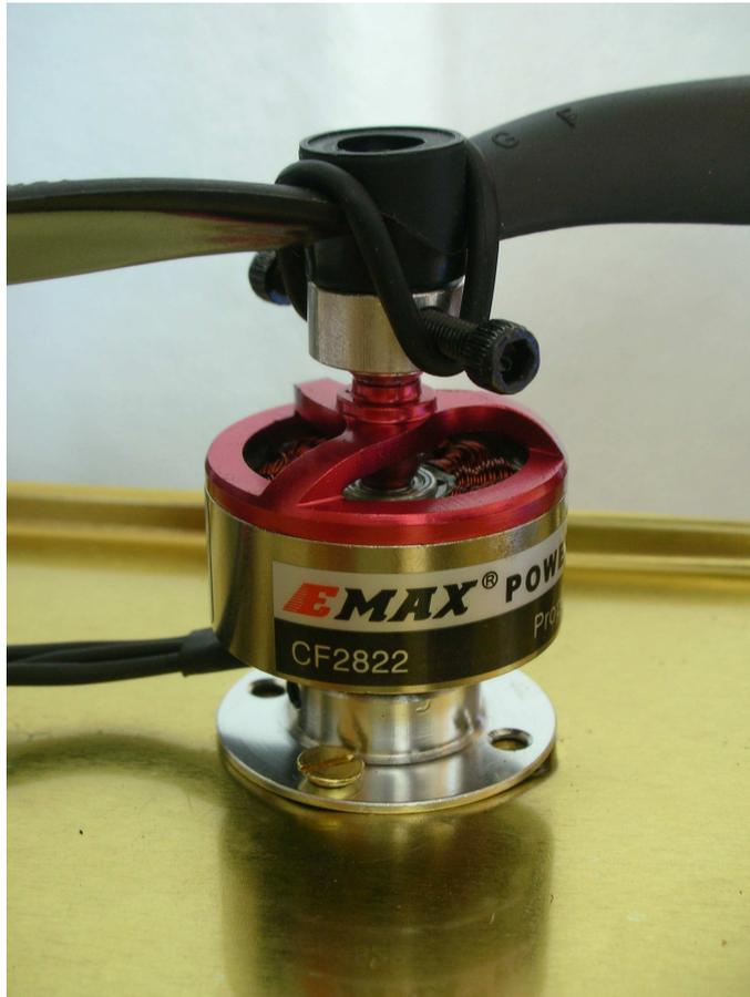
Figura 2.6: Motore fissato alla base in alluminio per la fase di identificazione
