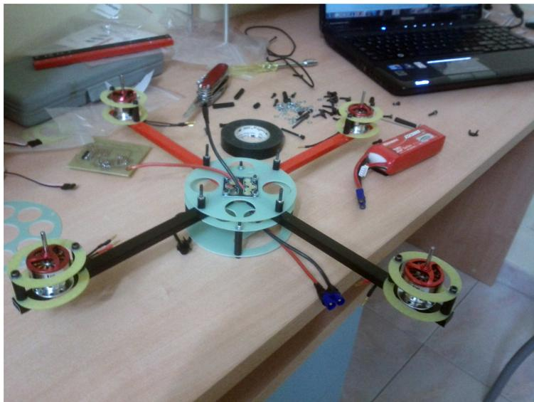
Figura 5.28: Passaggio dei cavi verso il vano batteria
