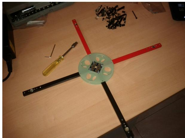
(b) I quattro bracci del telaio assemblati tramite la struttura centrale
