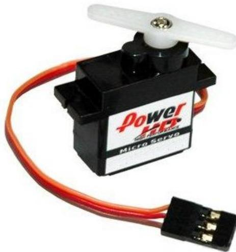
Figura 2.2: Servocomando Power HD-1900A
