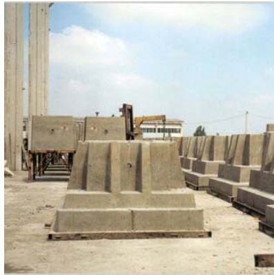
Fig.2-Plinto di fondazione prefabbricato.
