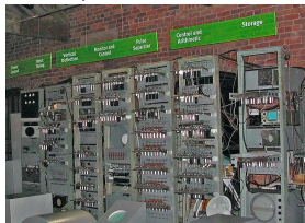
Colossus (Inghilterra, 1944): usato per decriptare codici durante la guerra. Elettronico, programma non in memoria (cavi e spinotti)
