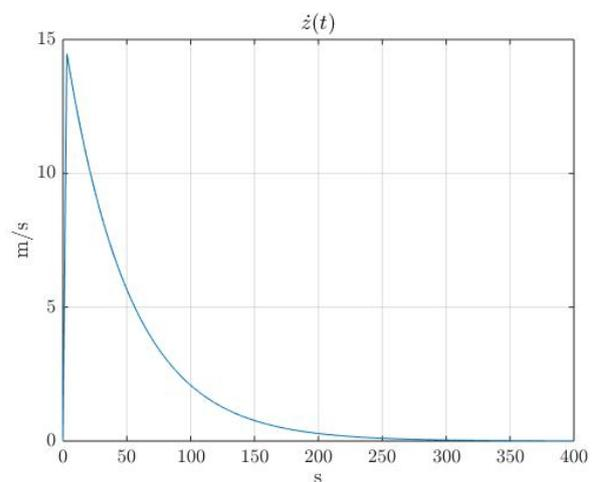
La figura precedente, a destro, illustra l'andamento della velocità del carrello. Si può notare come la velocità massima (14.5 m/s) sia raggiunta esattamente al cambio di pendenza, ovvero per  $t = 3s$ .
