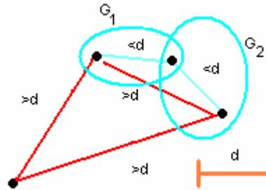
$$x_i \in G \Leftrightarrow \exists x_j \in G : d(x_i, x_j) < d_{\min} \wedge \forall x_j \in G : d(x_i, x_j) < d_{\max}$$
