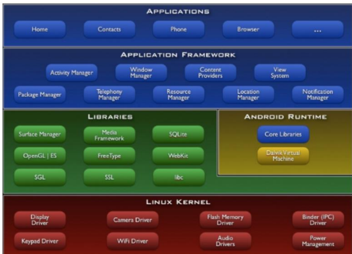
1.1 – Struttura a livelli di Android
